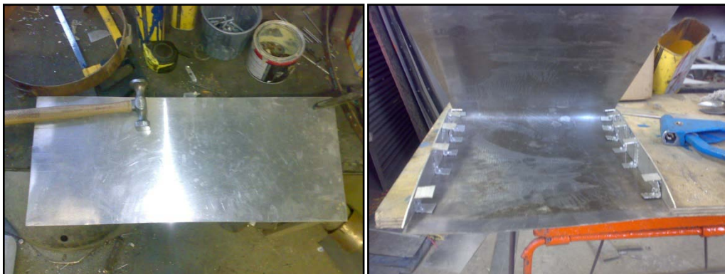
Foto. 3.10. Grapado y montaje de sensores en la estructura alar Fuente: Sr. Cevallos Cruz Luis Carlos
