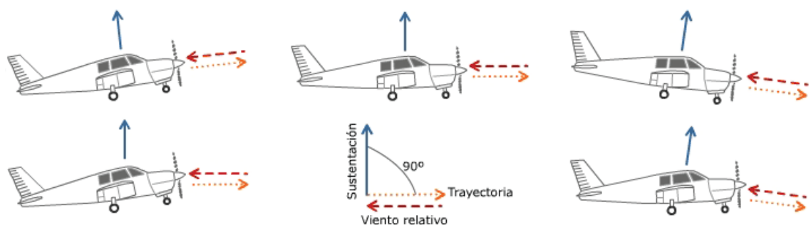
Fig. 8. La Sustentación es perpendicular viento relativo y opuesto y paralelo a la trayectoria.
