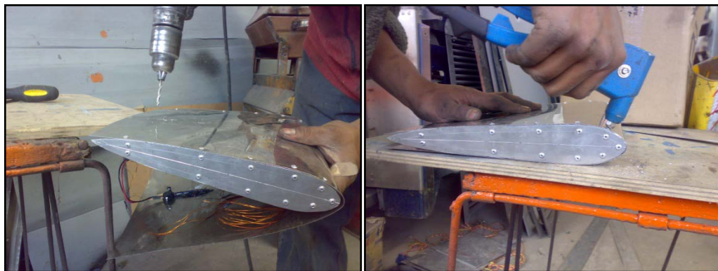
Foto. 3.12. Sellado de la estructura alar Fuente: Sr. Cevallos Cruz Luis Carlos
