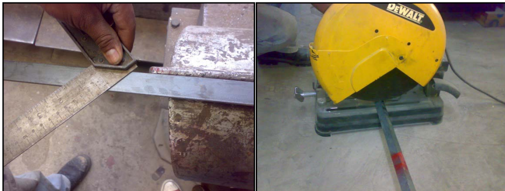
Foto. 3.2. Trazado y corte de la estructura base Fuente: Sr. Cevallos Cruz Luis Carlos
