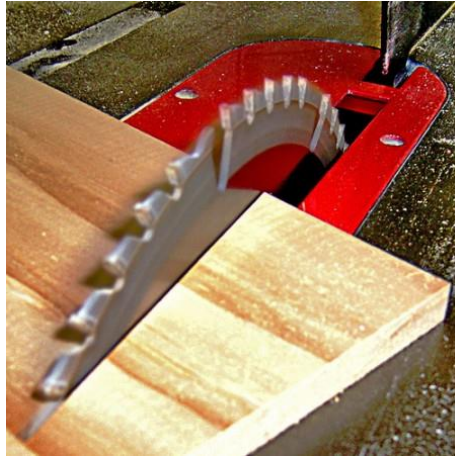
Fig. 3.10 Cuadre de la madera en los cuatro extremos.
