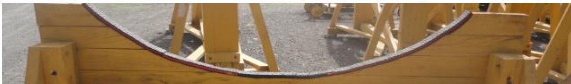
Fig. 3. 17 Colocación del caucho esponja en el filo del tablero
