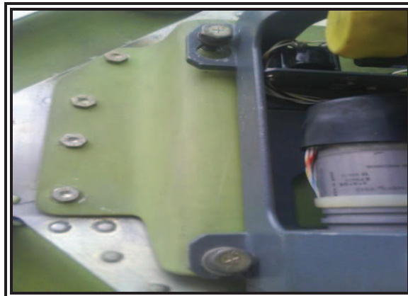
Figura 3.5 Antena en el Soporte Fuente: Fairchild FH-227 Realizado por: Andagana Nicolas
