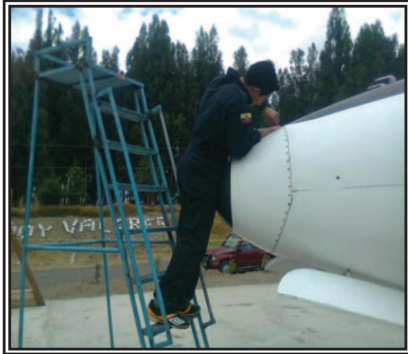
Figura: Remoción Radome Fuente: Fairchild FH-227 Matrícula HC-BHD Realizado por: Andagana Nicolas
