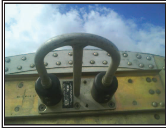
Figura 3.12 Glide Slope Antena Fuente: Fairchild FH-227 Realizado por: Andagana Nicolas
