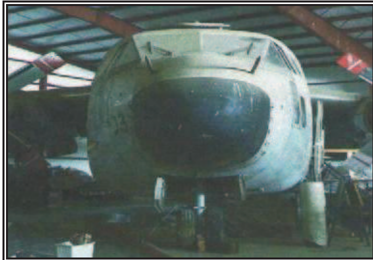
Figura 4.1 Radome del Avión FH-27J
