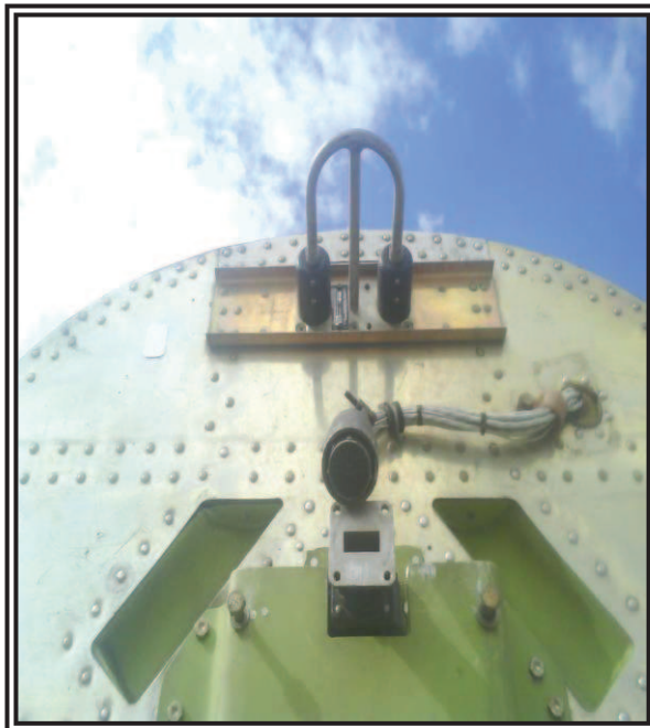
Figura: Antenna Glide Slope Fuente: Fairchild FH-227 Matrícula HC-BHD Realizado por: Andagana Nicolas
