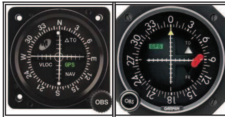
Figura 2.14 Selector de orientación (OBS)
