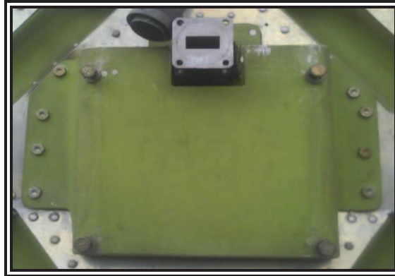
Figura 3.4 Soporte de Montaje Fuente: Fairchild FH-227 Realizado por: Andagana Nicolas
