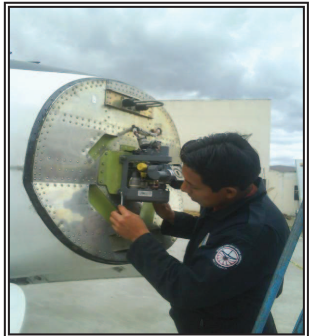
Figura: Radar Meteorológico Fuente: Fairchild FH-227 Matrícula HC-BHD Realizado por: Andagana Nicolas
