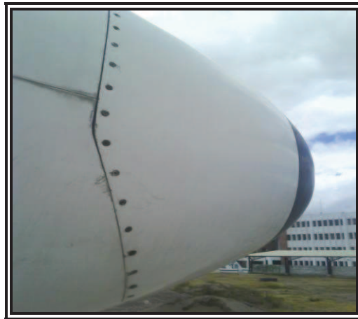
Figura 3.8 Cúpula o Radome
