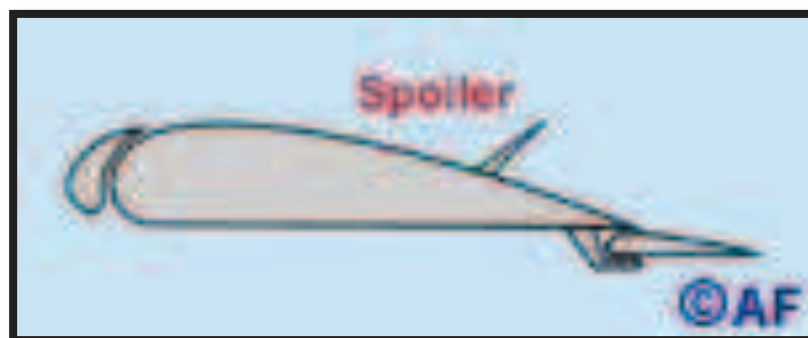
Figura 2.41. Spoiler desplegado sobre la superficie superior del ala.
