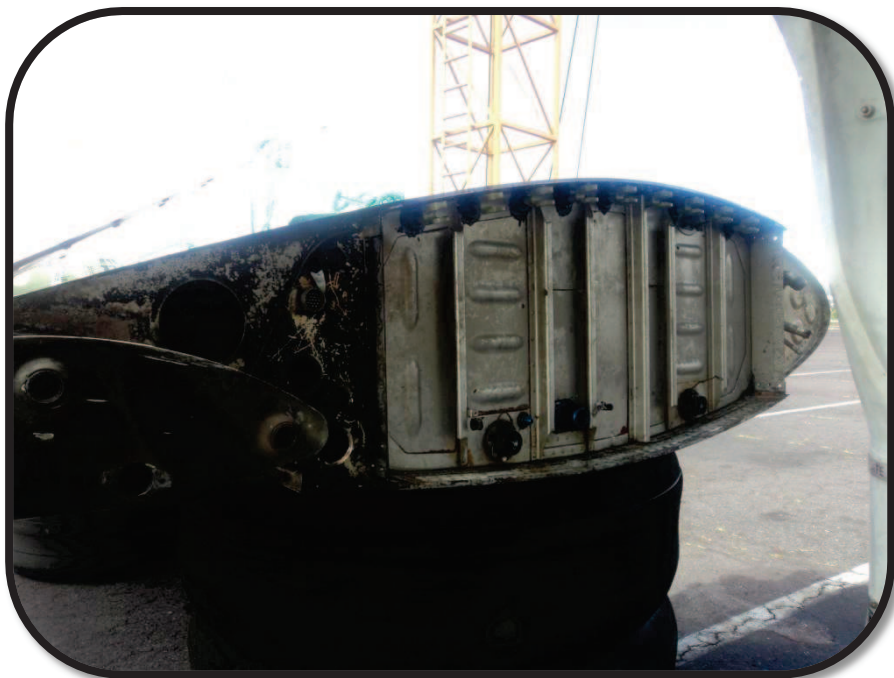
Fig. B14. Desconectado el ala
