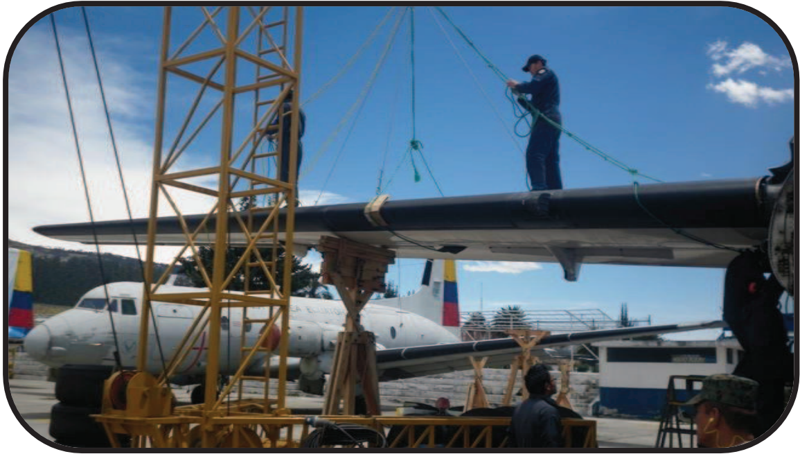
Fig. B11. Retiro de los soportes para la estabilidad del ala
