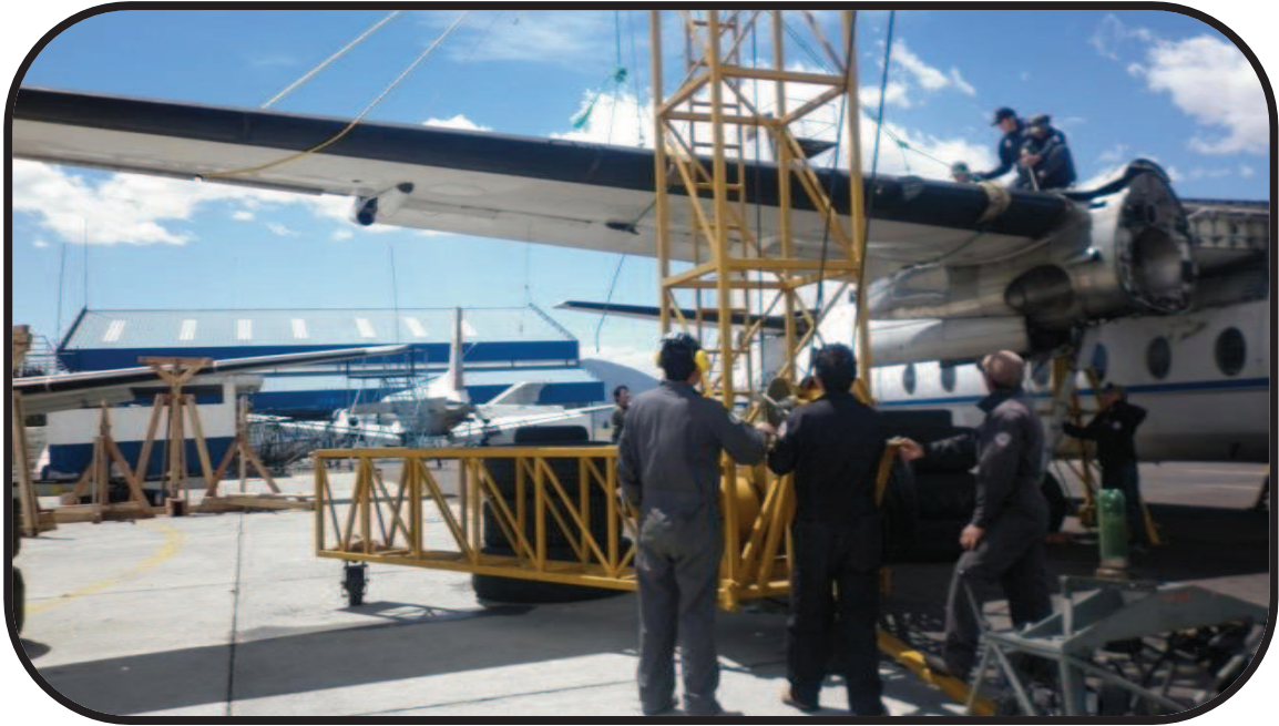
Fig. B9. Desmontando el ala
