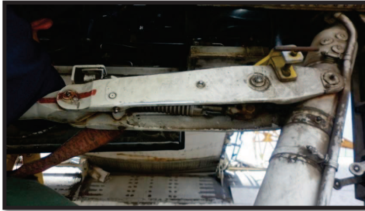
Figura 3.6 Acceso a la descohesión de tuberías y sistema eléctrico
