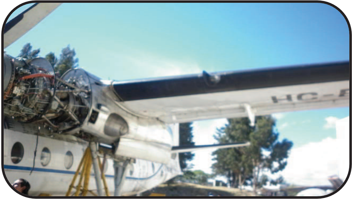
Fig. B3. Retiro de la placa de unión
