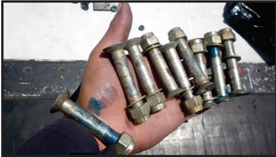
Figura 3.27 Los nueve pernos de sujeción del ala
