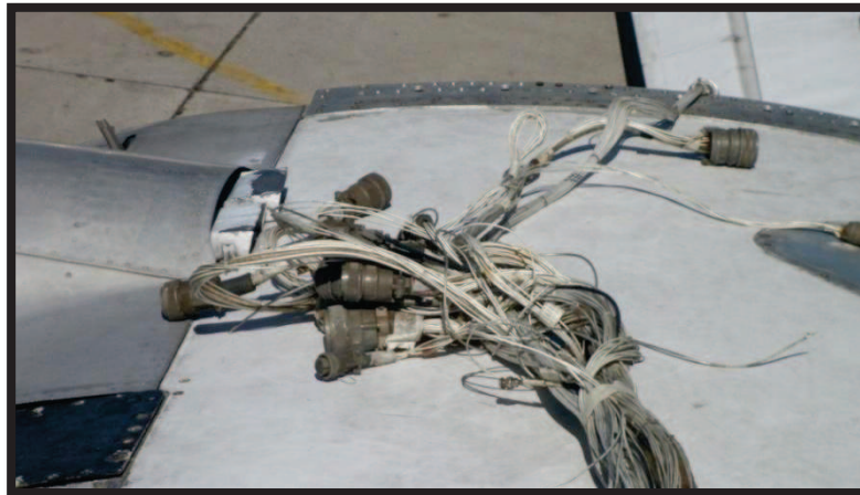
Figura 3.10 Sistema eléctrico desconectado y sin ala externa
