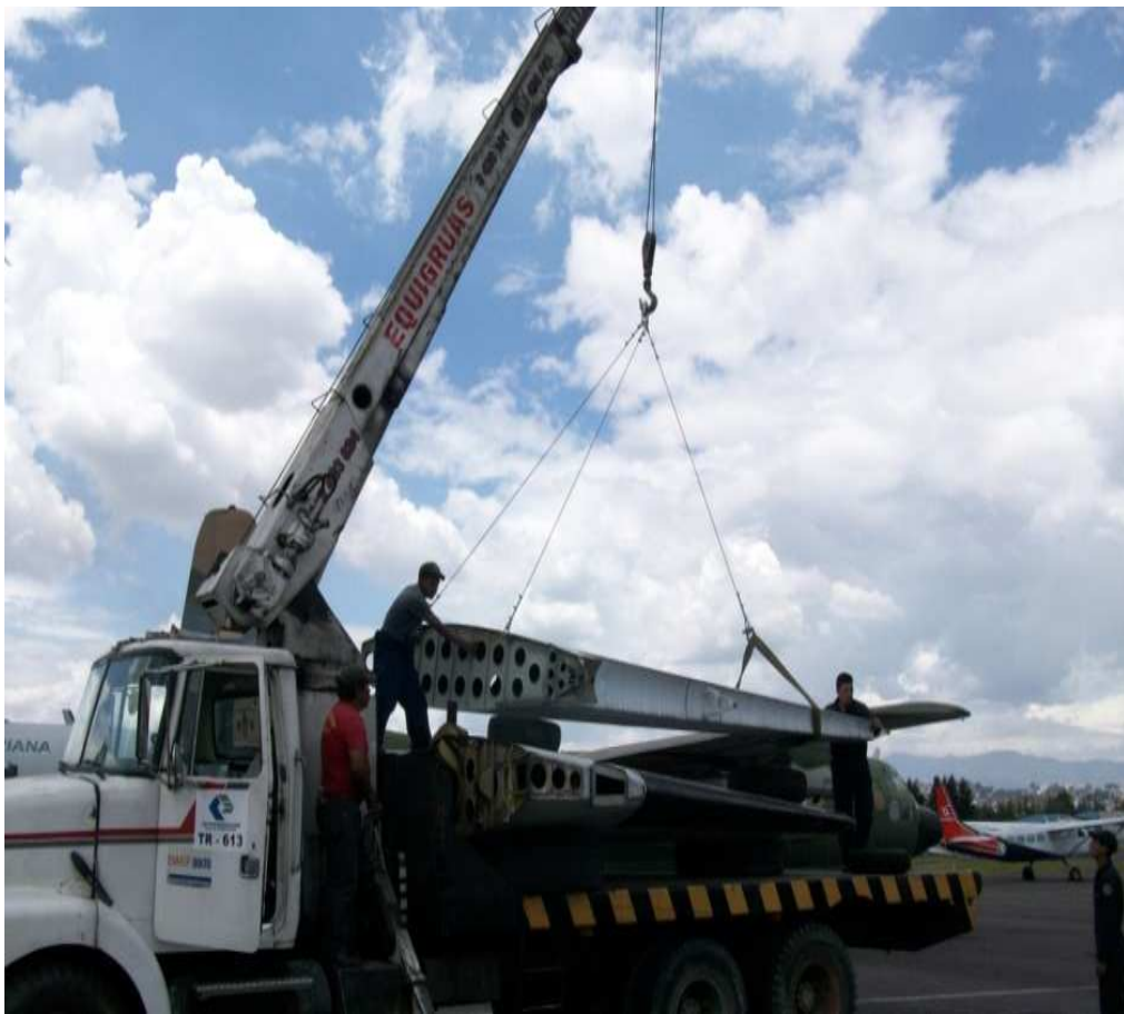
Figura 3.13 Aseguramiento a la plataforma del estabilizador vertical
