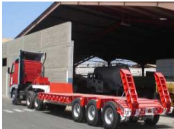
Figura 2.6 Equipo de transporte de Cama Baja utilizado para el traslado del avión Fairchild Hiller 227J
