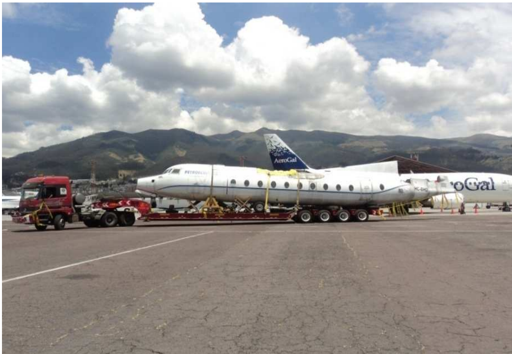
Figura 3.9 Aseguramiento del fuselaje a la Plataforma Extendible
