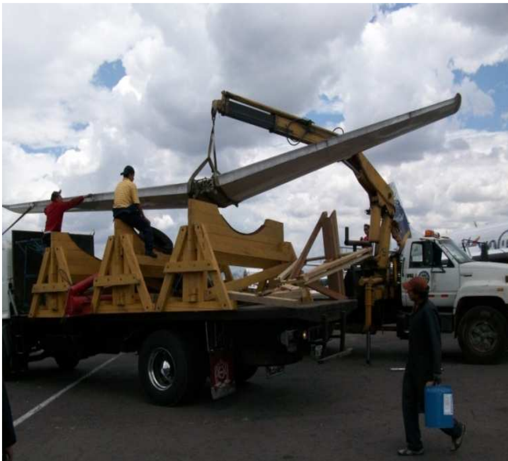
Figura 3.12 Aseguramiento del estabilizador horizontal a la plataforma.
