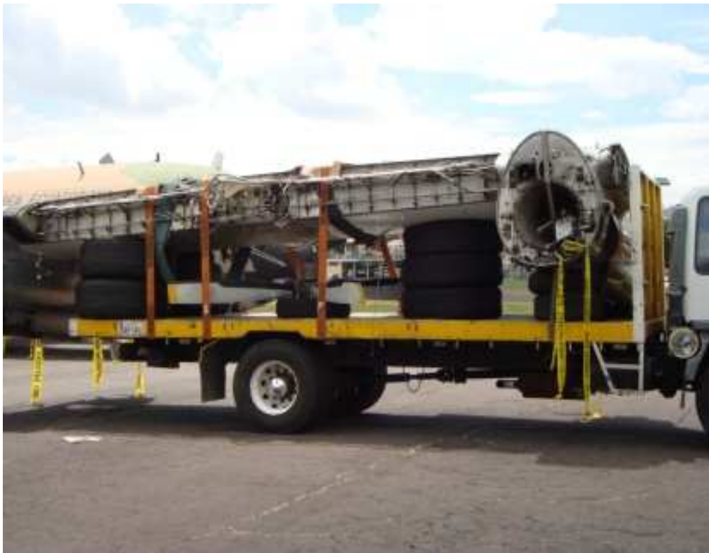
Figura 3.11 Aseguramiento a la plataforma del ala intermedia
