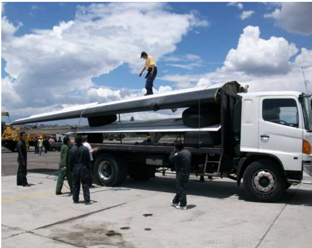
Figura 3.10 Aseguramiento de la parte exterior izquierda del ala a la plataforma.
