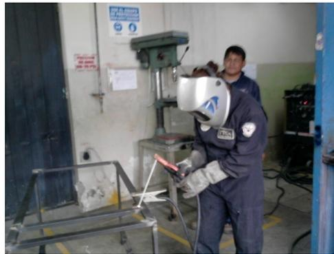
**Fig. 3.69.** Unión de piezas por soldadura de arco eléctrico
