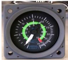
**Fig. 2.27.** Combinación de indicador de presión diferencial y altímetro de cabina.
