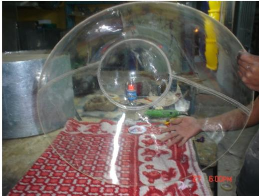
**Fig. 3.52.** Unión de partes con pegamento especial para acrílico
