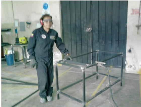
**Fig. 3.68.** Unión y escuadre de piezas del bastidor
