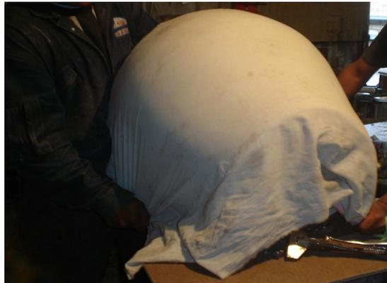
**Fig. 3.49.** Tapado del molde matriz base para calentamiento en el horno
