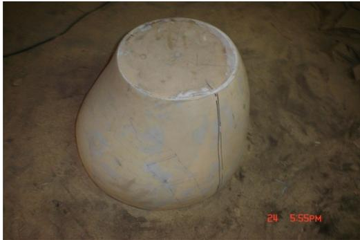
**Fig. 3.43.** Moldeo de la matriz base para la cabina
