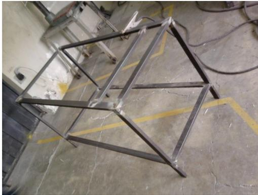
**Fig. 3.71.** Proceso de soldadura de bastidor culminado
