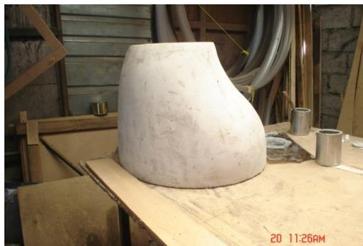
**Fig. 3.44.** Moldeo de la panza de la matriz base para la cabina
