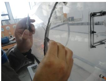
**Fig. 3.88.** Sellado de fuselaje
