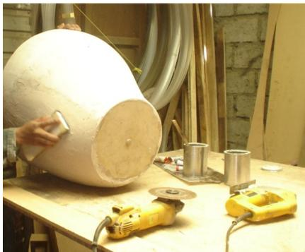
**Fig. 3.42.** Lijado de la matriz base para la cabina
