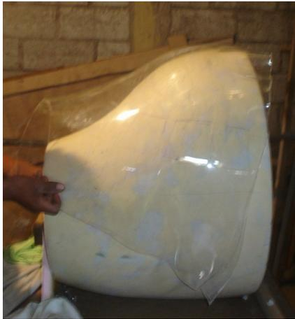
**Fig. 3.48.** Ajuste del PMMA a la cabina para el proceso de calentamiento
