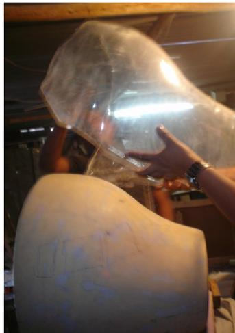
**Fig. 3.47.** Colocación del PMMA en el molde
