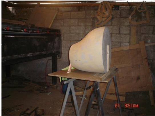
**Fig. 3.50.** Enfriamiento del molde matriz base con PMMA de de la cabina
