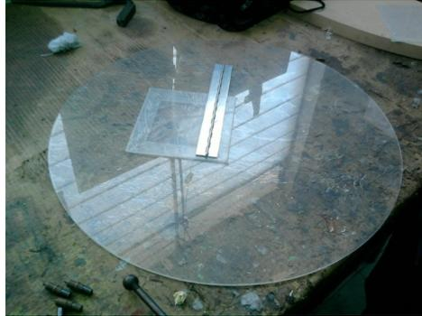
**Fig. 3.63.** Tapa de sellado de fuselaje
