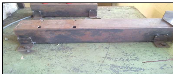
Fig. 39. Tubo cuadrado de 4" instalado a la plancha de tol.
