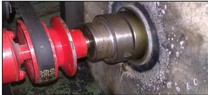
Fig. 38. Eje de movimiento con el acople metálico acoplado al magneto.
