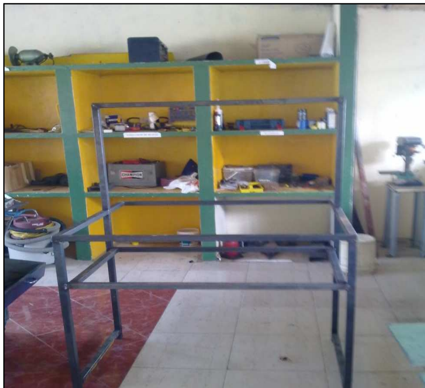
Fig. 28. banco de prueba soldado
