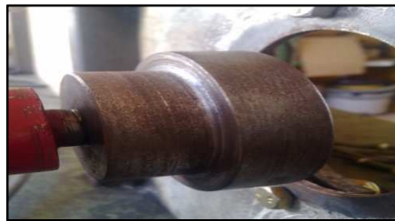
Fig. 36. Acople metálico para el magneto.
