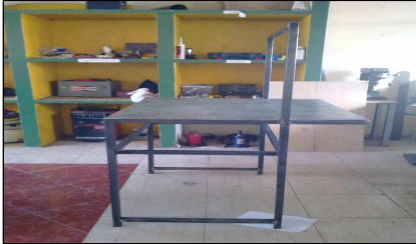
Fig. 31. Instalación de la plancha de tol en la estructura.
