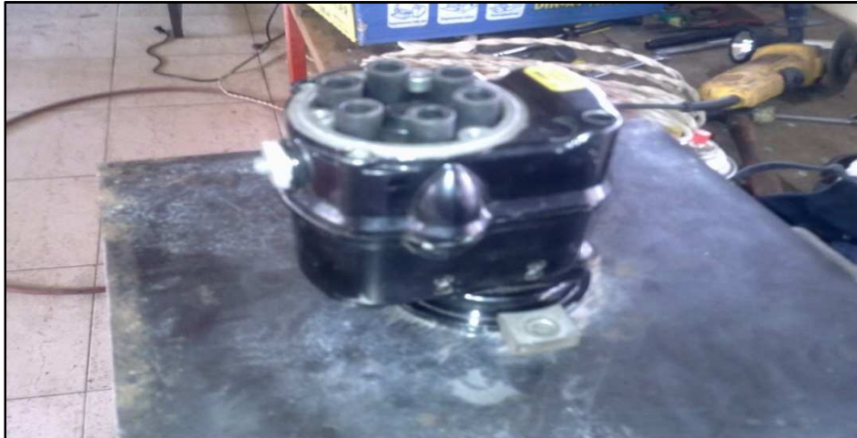
Fig. 33. Verificación del magneto al orificio de la placa de tol.
