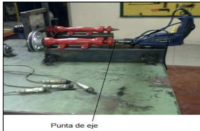
Fig. 42. Instalación del taladro
