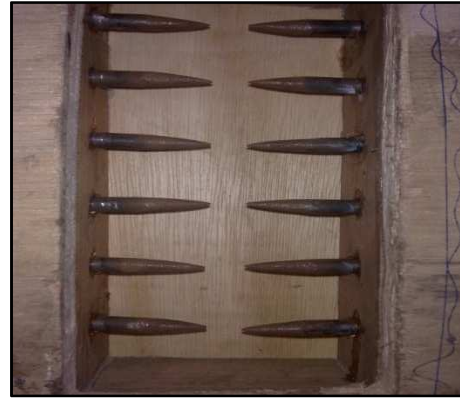
Fig. 46. Transmisores de energía (pernos limados) para magnetos de 4 y 6 cilindros.
