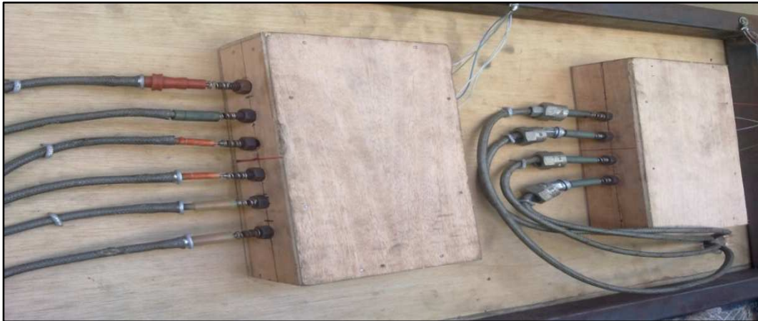
Fig. 48. Instalaciones de arnés de encendido a los transmisores de energía de las cajas.
