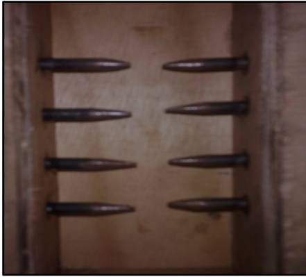
Fig. 46. Transmisores de energía (pernos limados) para magnetos de 4 y 6 cilindros.
