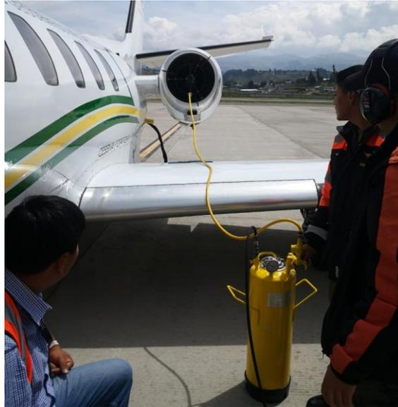
**Figura 51.** Desalinización del compresor
