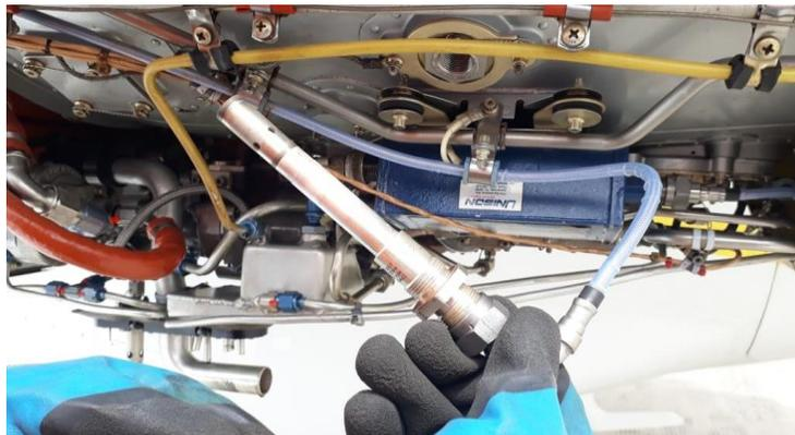
**Figura 48.** Encendedor de chispa retirado
