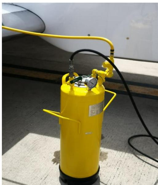
**Figura 30.** Reservorio de agua destilada y alcohol metílico
