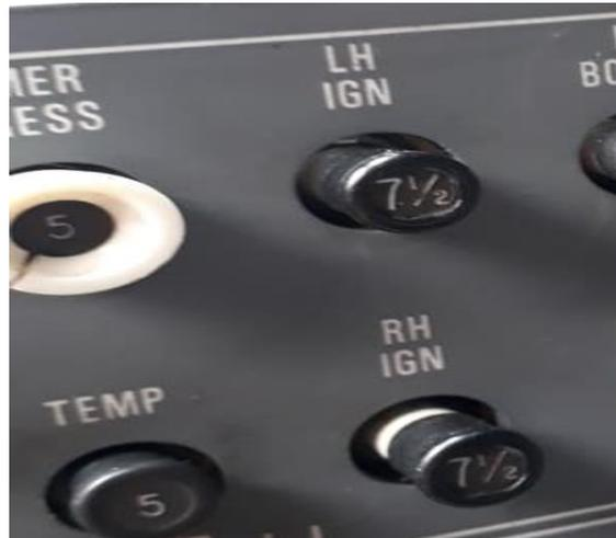
**Figura 44.** Disyuntores de ignición aislados
