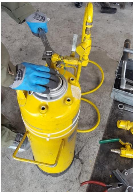
**Figura 22.** Válvulas y manómetro reemplazado
