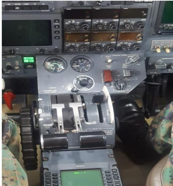
**Figura 33.** Palanca de potencia en CUT-OFF
