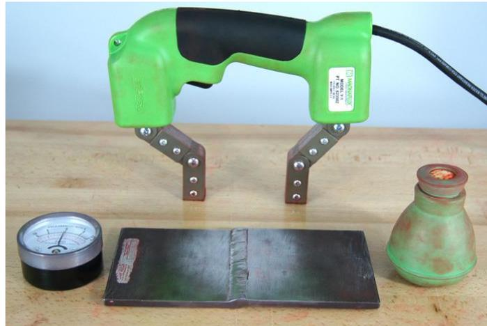
**Figura 12.** Inspección por partículas magnéticas
