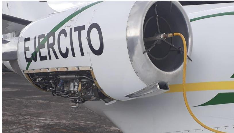
**Figura 40.** Plataforma de lavado instalada
