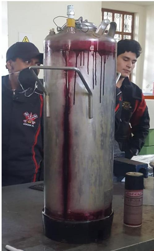
**Figura 19.** Aplicación líquido penetrante
