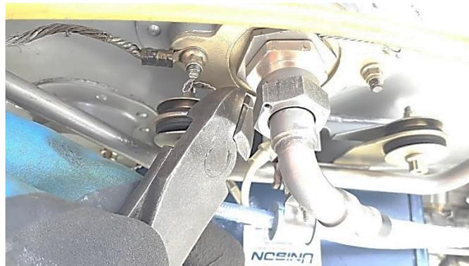
**Figura 45.** Alambre de seguridad retirado
