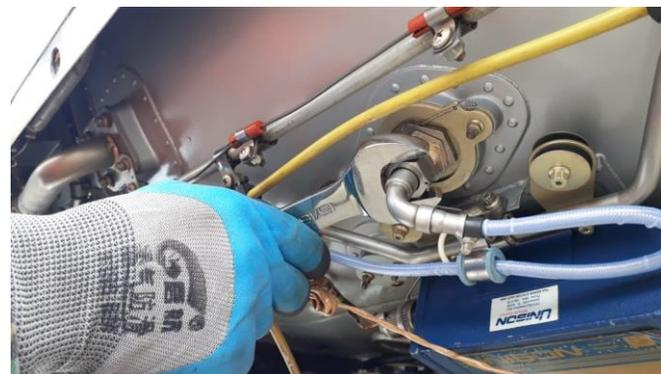
**Figura 46.** Retirando acoples de conjunto de cables
