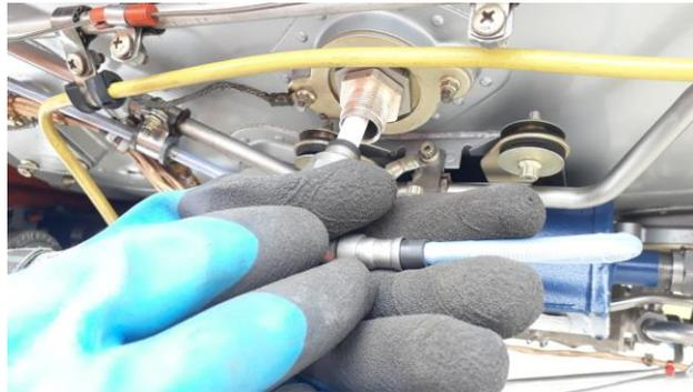
**Figura 47.** Descarga de corriente residual
