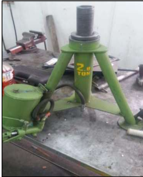
Figura 40. Gata Hidráulica después de mantenimiento
