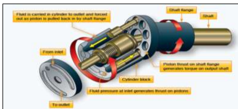
Figura 13. Motor hidráulico de eje doblado Fuente: (FEDERAL AVIATION ADMINISTRATION, 2018)
