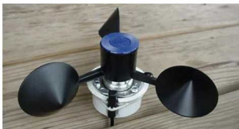
Figura 2: Generador Eléctrico de un Anemómetro
