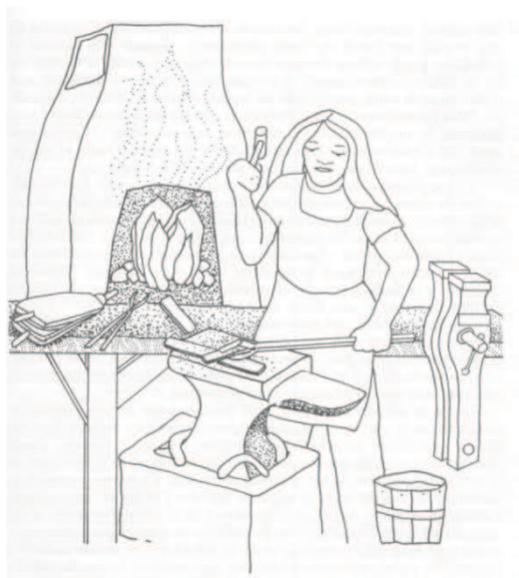
Figura 2.1. Forma antigua de soldadura.
