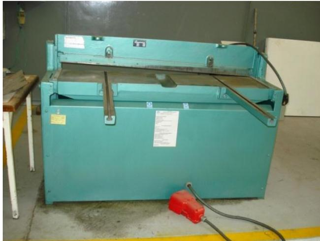
Foto 3.6. Cizalla Hidráulica
