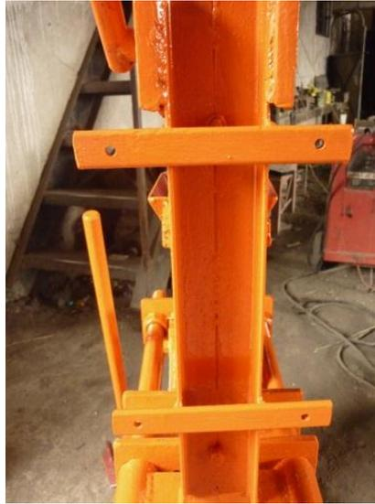
Foto 3.15. Platinas para colocar la Caja de Control
