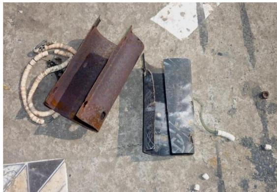
Foto 3.4. Partes dañadas del Sistema Térmico-Eléctrico de la Máquina Inyectora de Plástico
