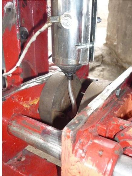
Foto 4.3. Fusión e Inyección de la materia prima
