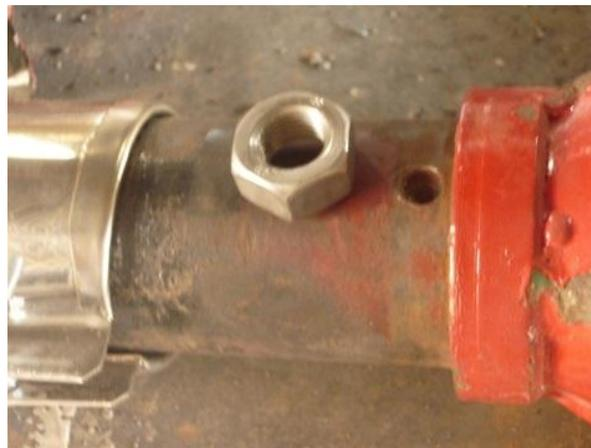
Foto 3.14. Tuerca de Adaptación para colocar de la Termocupla
