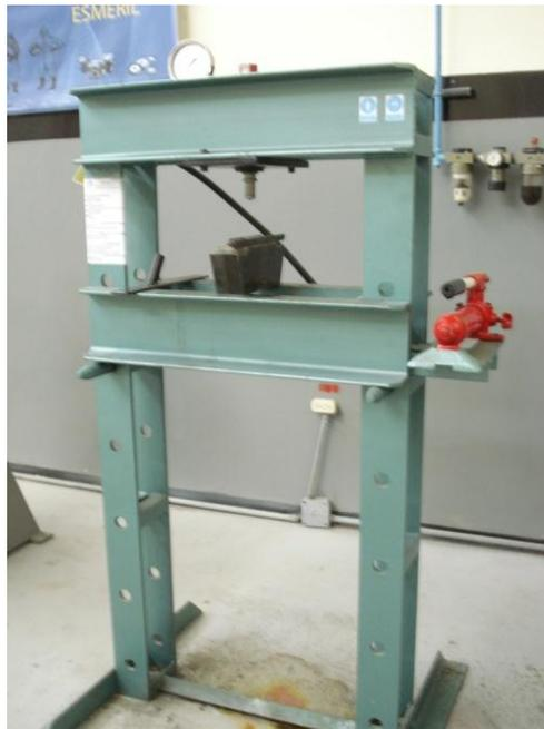
Foto 3.13. Prensa Hidráulica
