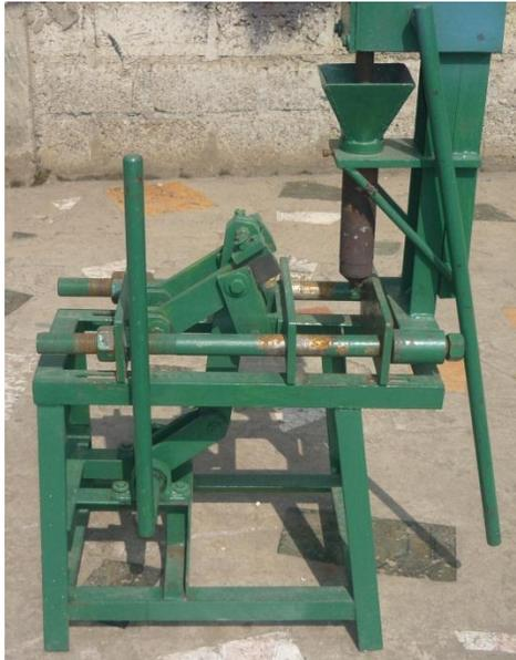
Foto 3.5. Bastidor y Estructura de la Máquina Inyectora de Plástico
