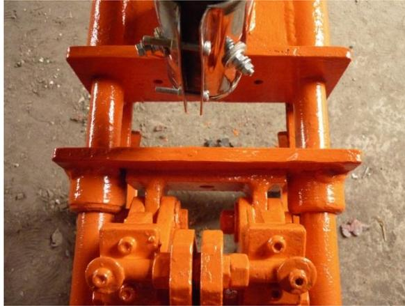
Foto 3.10. Sistema de Cierre de la Máquina Inyectora de Plástico Modificado
