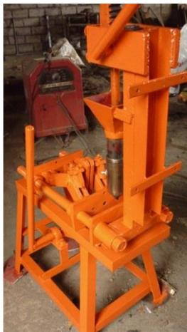
Foto 3.17. Máquina Inyectora de Plástico pintada
