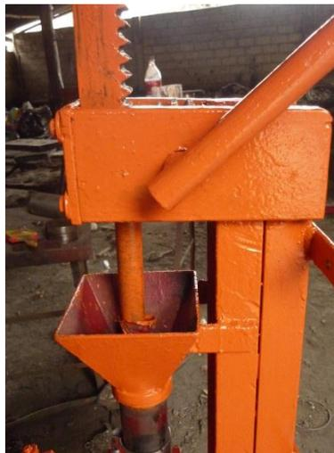
Foto 3.9. Sistema de Inyección de la Máquina Inyectora de Plástico Modificado
