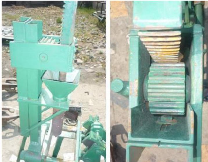
Foto 3.1. Sistema de Inyección de la Máquina Inyectora de Plástico
