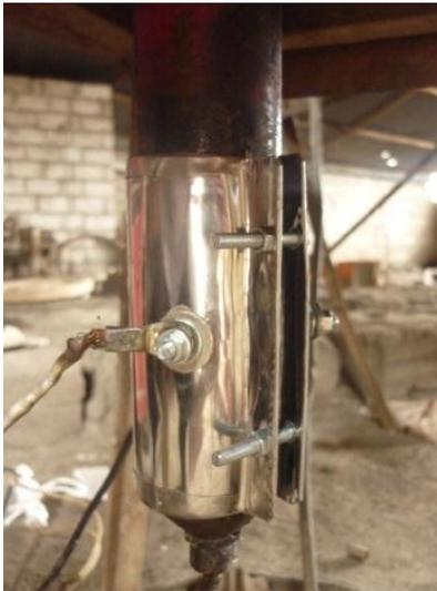
Foto 3.11. Resistencia Abrazadera colocada en la Máquina Inyectora de Plástico
