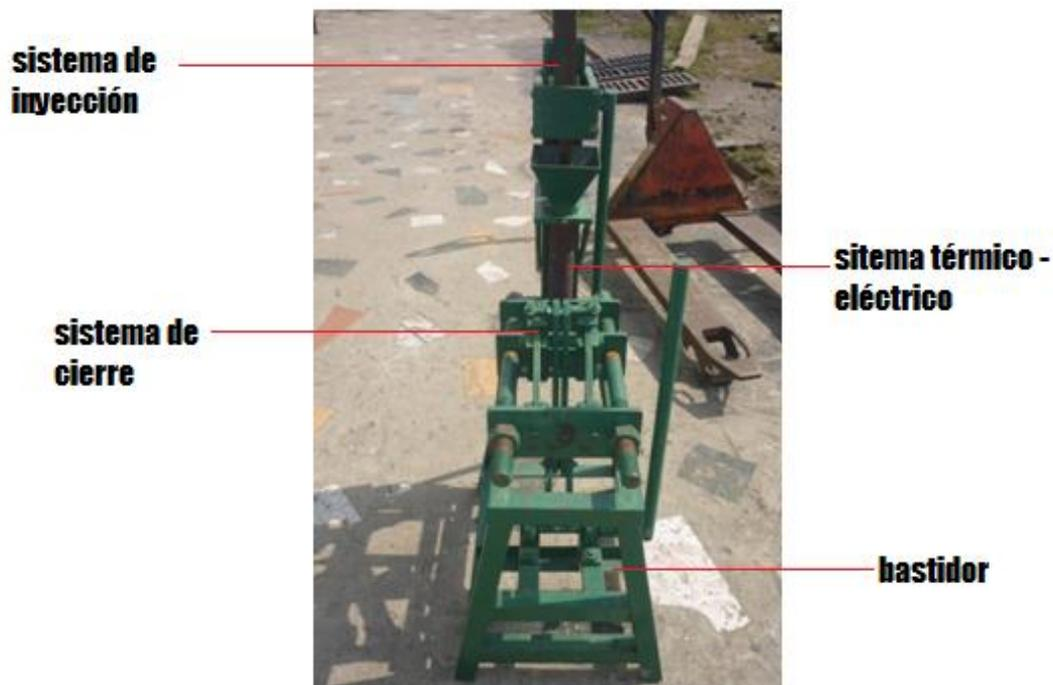
Foto 2.1. Partes Básicas de una Máquina Inyectora de Plástico
