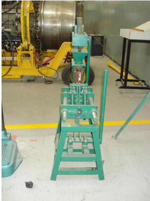
Foto 3.19. Máquina Inyectora de Plástico
