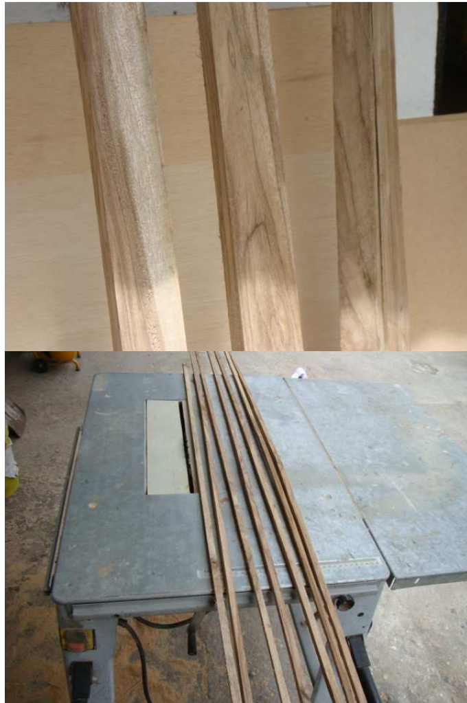
Foto 6.6 Corte de largueros larguerillos del avión telégrafo
