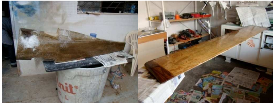
Foto 6.17 Aplicación de la primera capa de resina epóxica y fibra de vidrio
