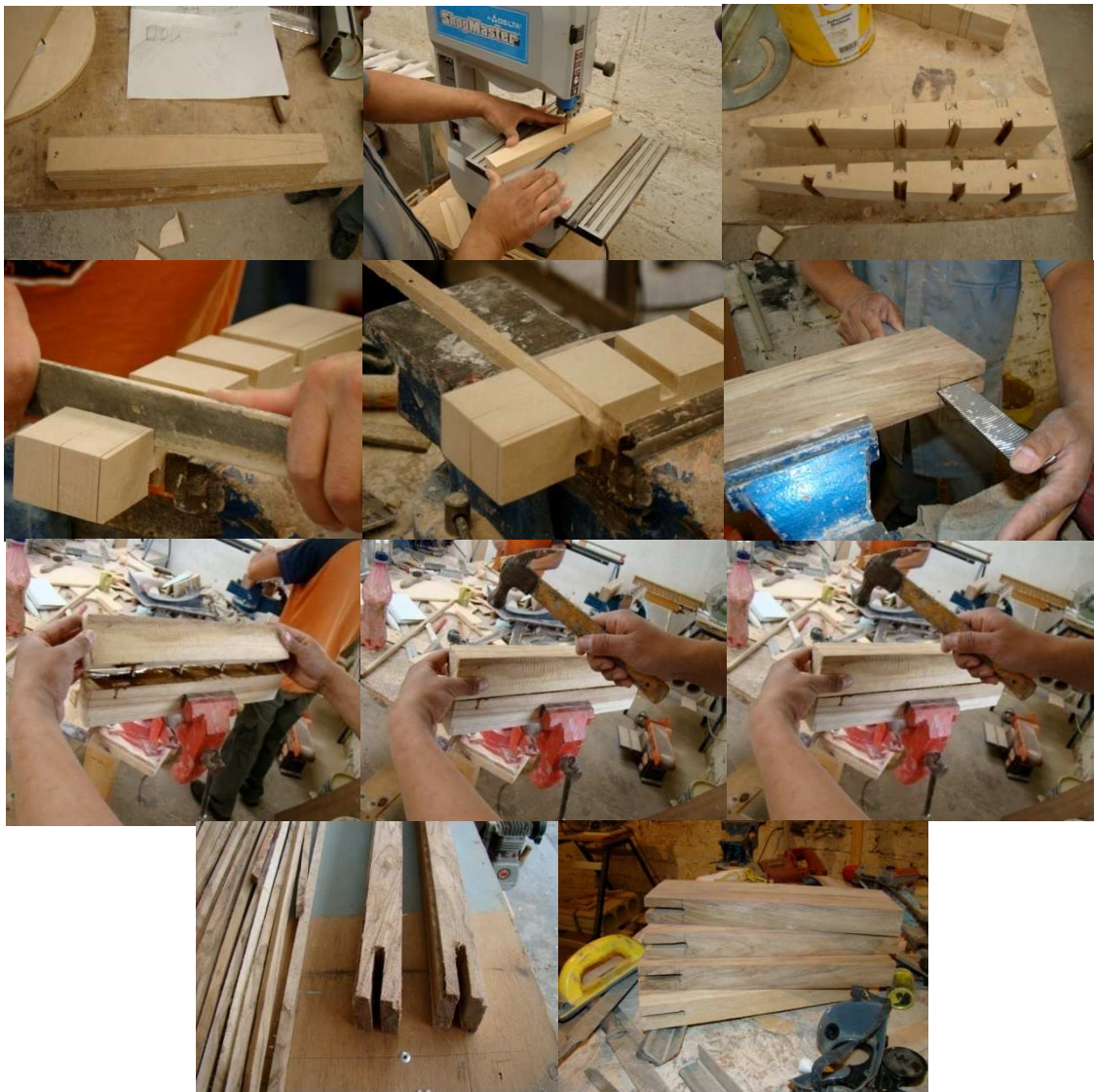
Foto 6.9 Recorte de piezas para las alas y partes críticas
