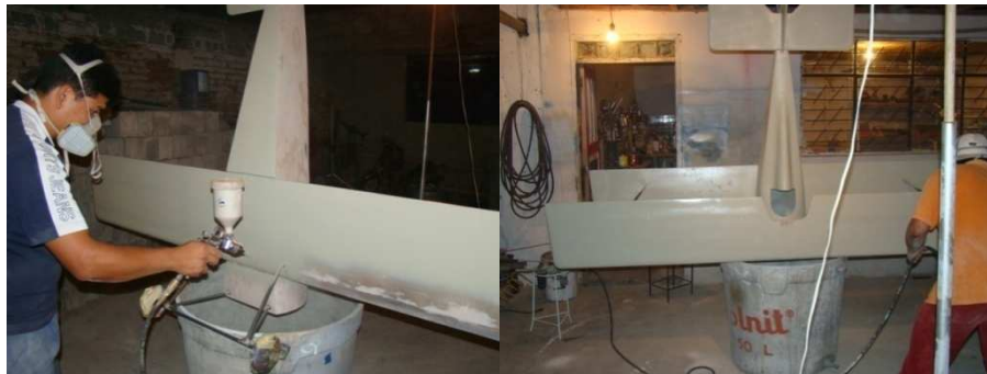
Foto 6.22 Pintado con fondo de prymer de poliuretano Fuente: hbdfly model company Elaborado por: Cbos. Tec. Avc. Celi Sánchez Luis
