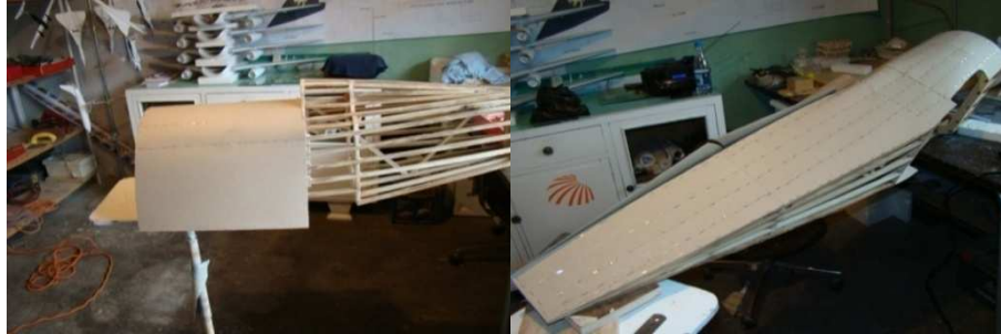
Foto 6.8 Forrado del fuselaje
