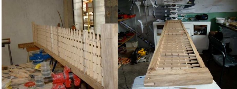
Foto 6.11 Armado de la estructura de las alas
