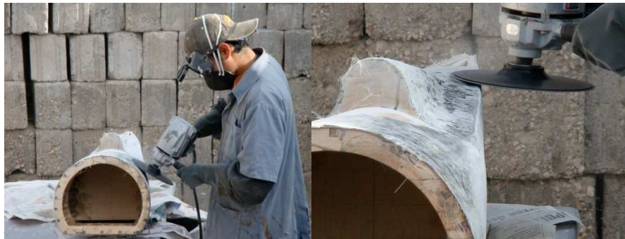
Foto 6.19 Secado y pulido de la fibra Fuente: hbdfly model company Elaborado por: Cbos. Tec. Avc. Celi Sánchez Luis
