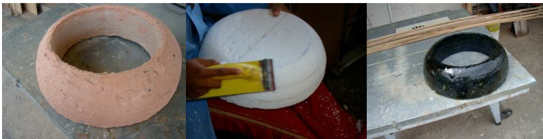
Foto 6.14 Construcción de parte frontal del motor del avión telégrafo
