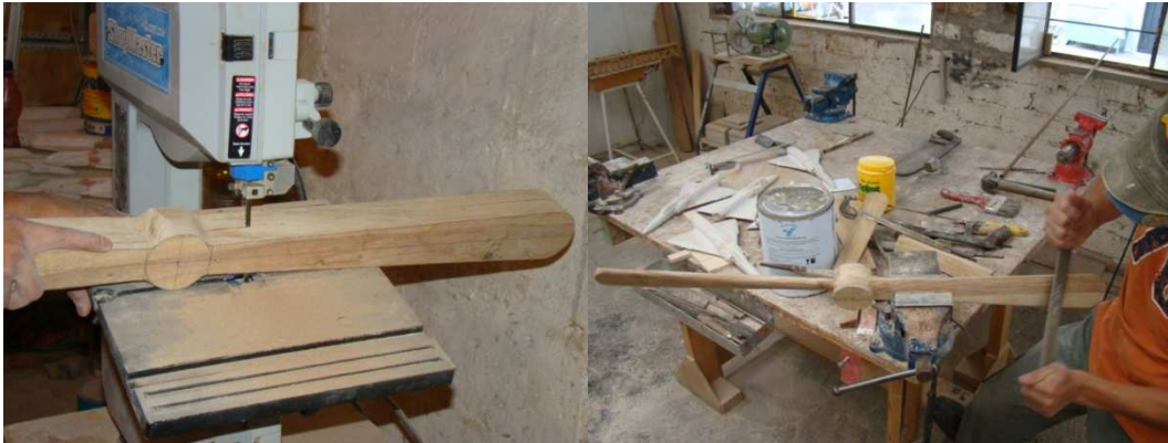
Foto 6.13 Construcción de la hélice
