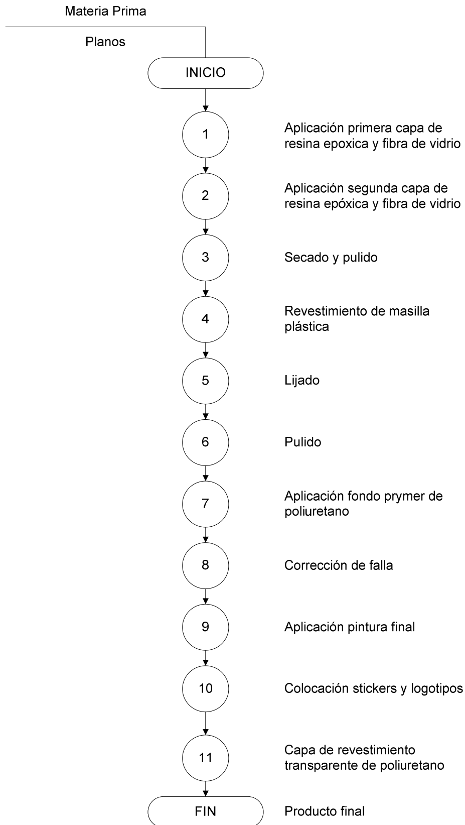
Figura 6.10 Proceso de terminado de la maqueta Elaborado por: Cbos. Tec. Avc. Celi Sánchez Luis
