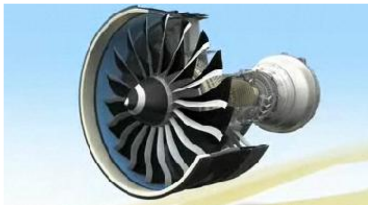
Figura 3.20 Fan y conjunto de entrada de aire en el motor GenX Fuente: http://www.geae.com/education/theatre/genx/
