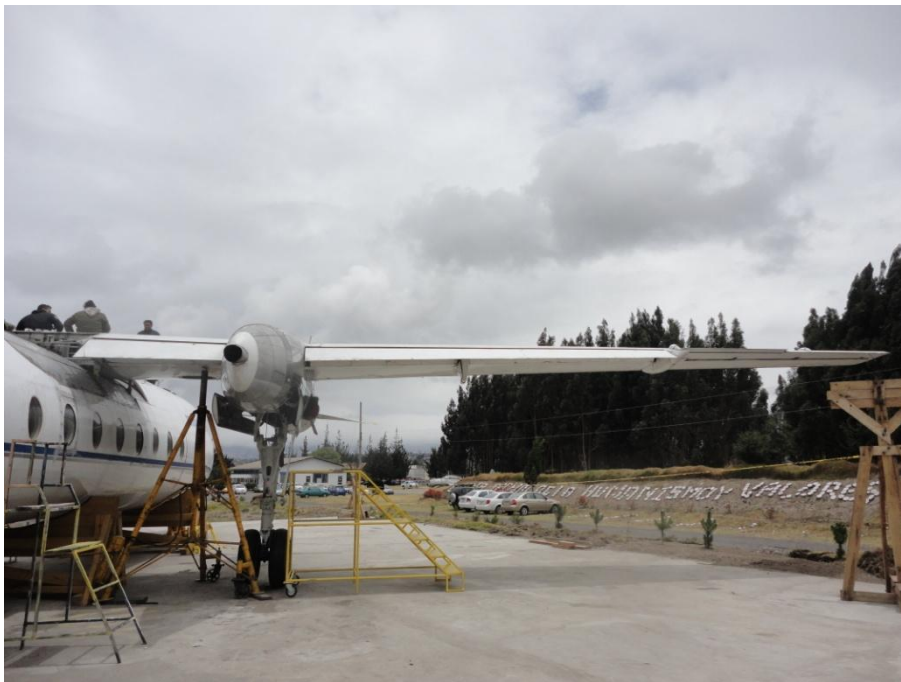
Img. Montaje de los controles de vuelo del ala derecha
