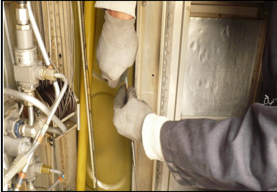
Figura 3.57: Aseguramiento de turnbuckles
