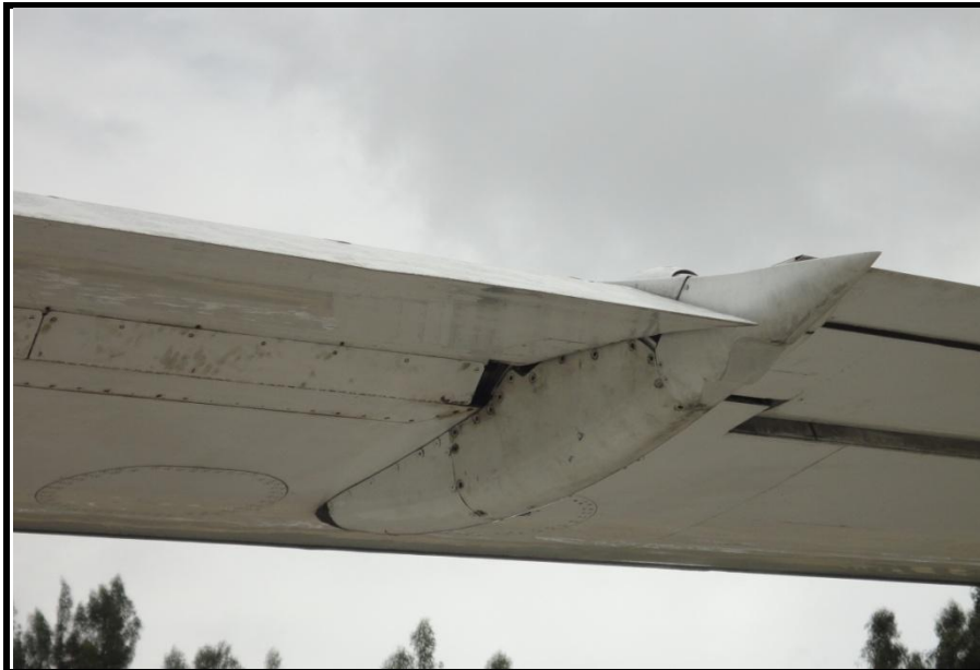
Figura 3.14: instalación de carenados
