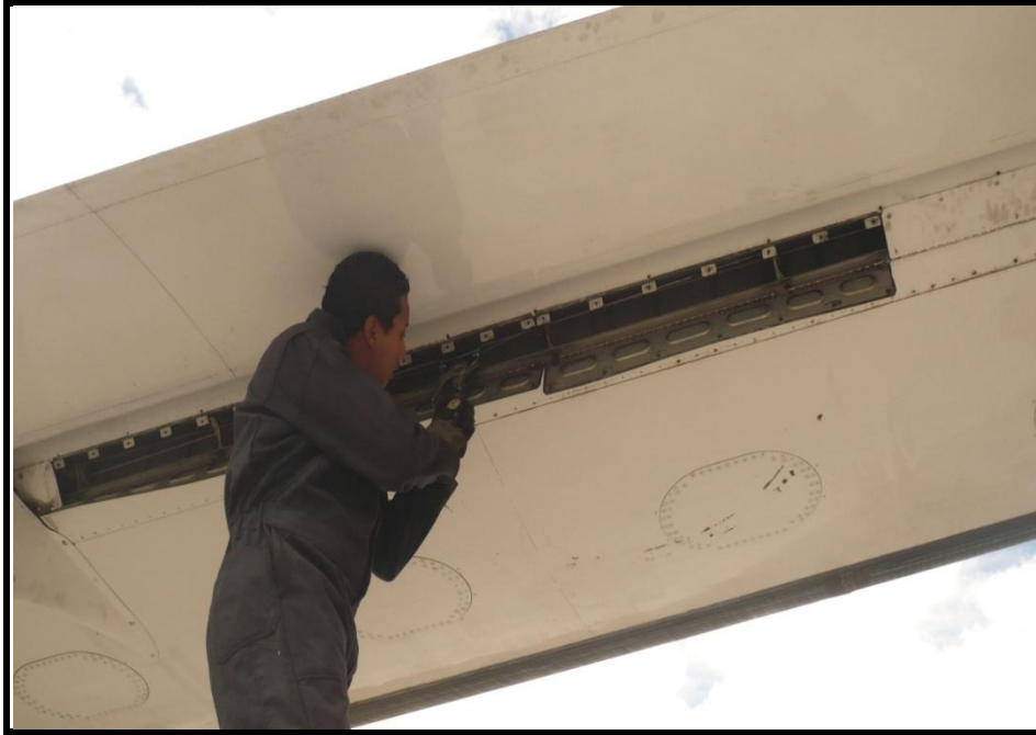
Figura 3.53: Tensionando los cables del spring tab
