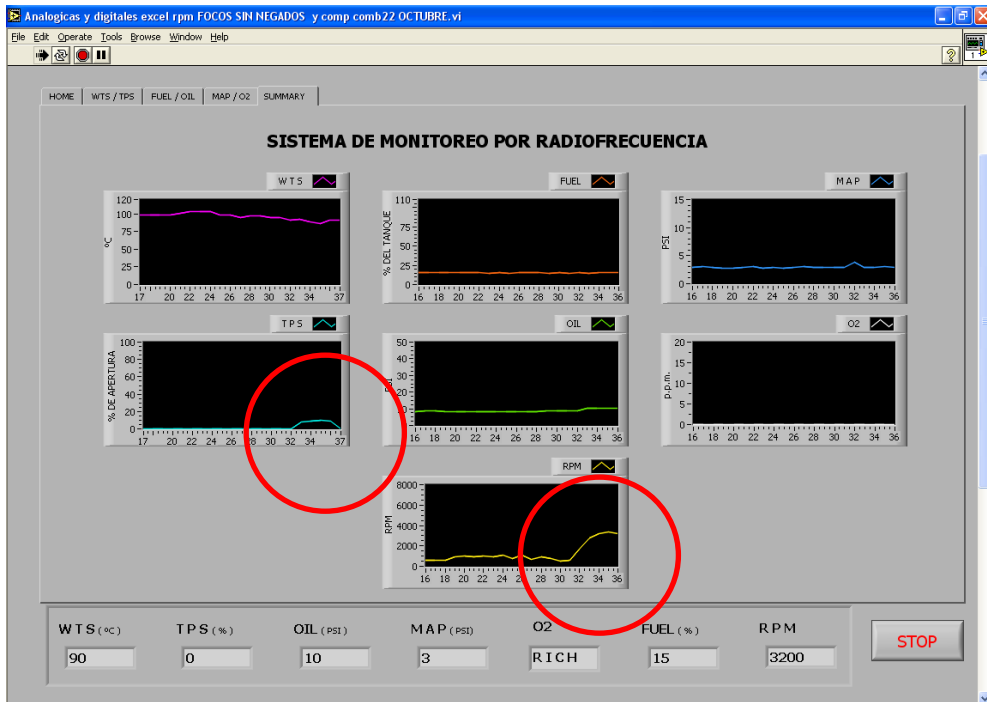
Figura 3.21 Pantalla Inicial Comportamiento del vehículo desconectado el sensor Oxígeno (3200 RPM)
