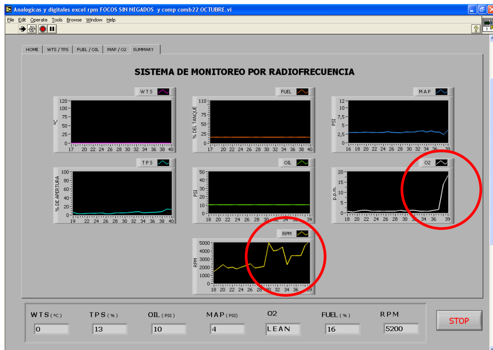
Figura 3.10 Pantalla Inicial Comportamiento del vehículo desconectado el sensor WTS (5200 RPM)
