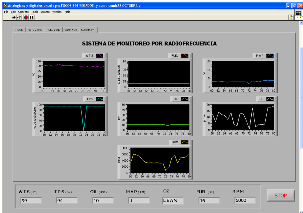
Figura 3.15 Pantalla Inicial Comportamiento del vehículo desconectado el sensor TPS (6000 RPM)
