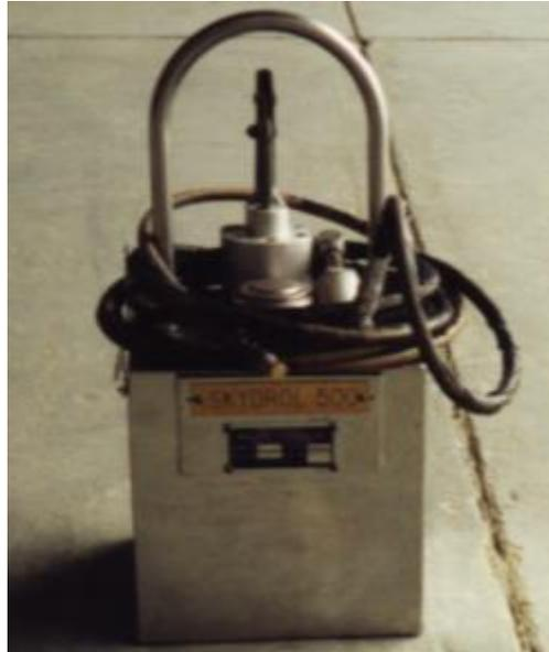
**Figura 1.4:** Suministrador de líquido hidráulico para el avión Boeing.
