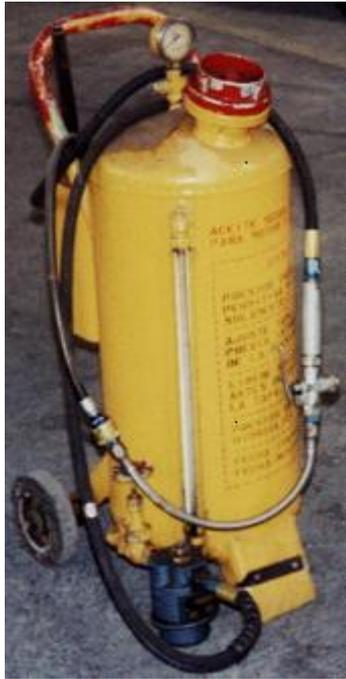
**Figura 2.2:** Coche suministrador de líquido Hidráulico neumático.
