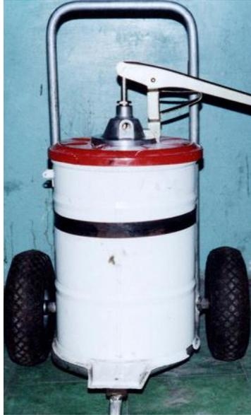
**Figura 2.1:** Coche suministrador de líquido Hidráulico manual.
