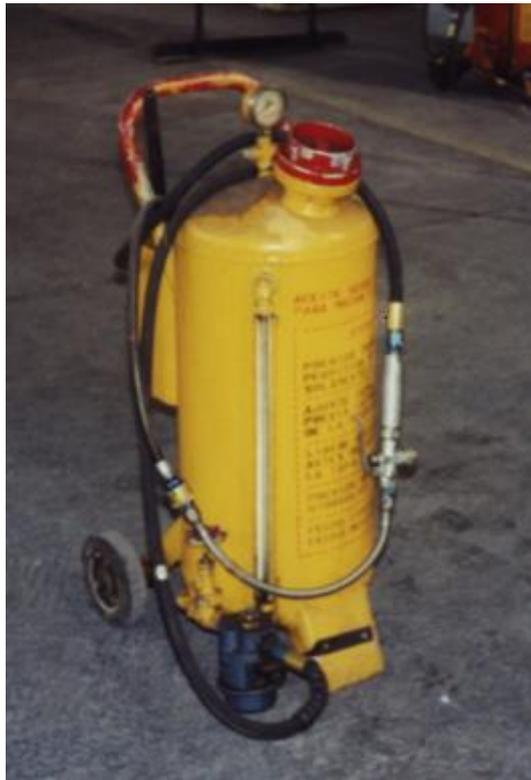
**Figura 1.3:** Suministrador de líquido hidráulico para el avión Kfir.
