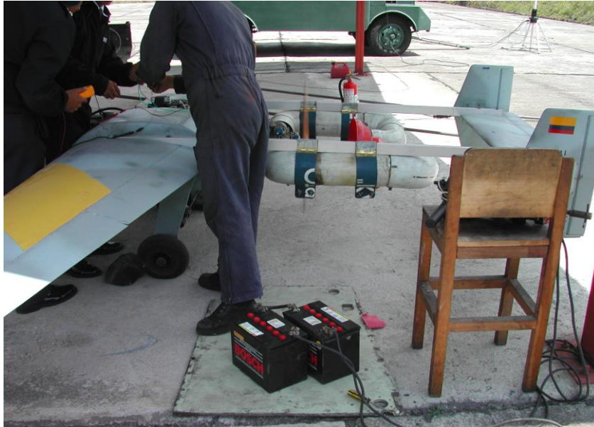
Figura 3.22 Arranque de la aeronave
