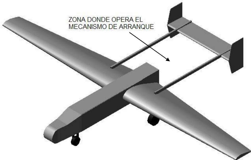
Figura 4.1 Restricción de espacio del mecanismo de arranque
