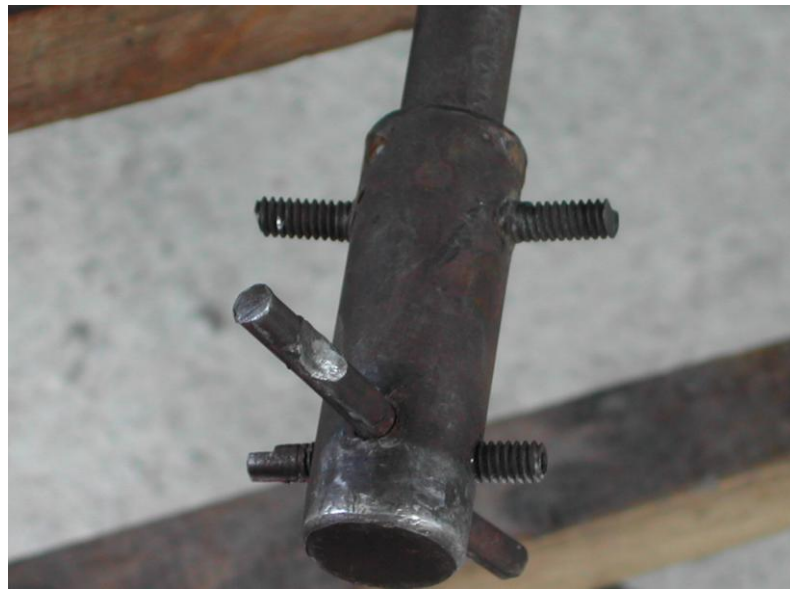
Figura 3.7 Cruceta que fue acoplada al eje del arrancador Bosch
