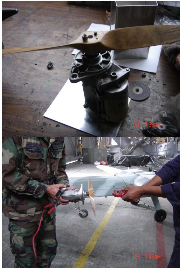
Figura 3.12 Prueba para medir las RPM del arrancador NIPPONDENSO y hélice empleada para el efecto
