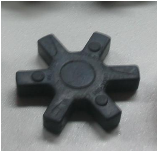
Figura 3.21 Modificación del caucho del acople
