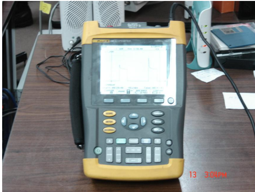
Figura 3.8 Oscómetro FLUKE 196 empleado para analizar el voltaje
