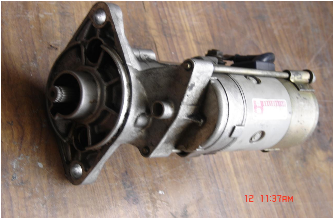
Figura 3.11 Arrancador NIPPONDENSO S-ND16878 empleado en el Proyecto RPV “COTOPAXI”
