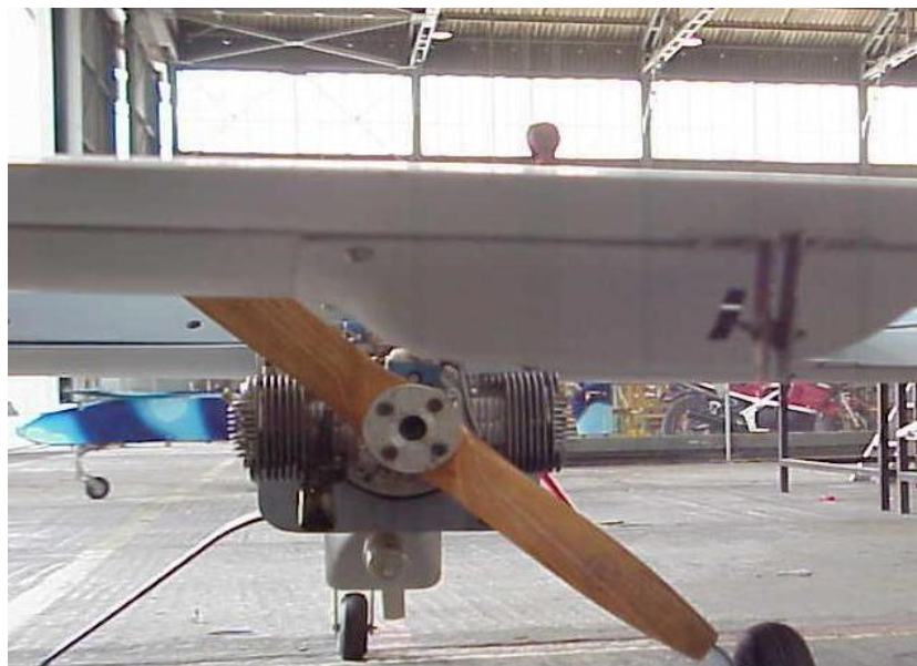
Figura 1.3 Vista posterior del RPV con motor Meggitt WAE 342 y hélice
