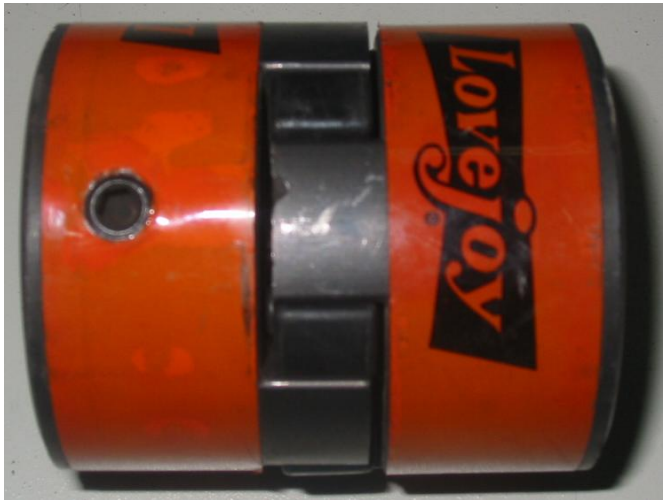
Figura 3.17 Acople empleado en generadores eléctricos
