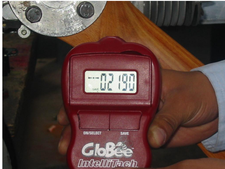
Figura 3.16 RPM que marcó el tacómetro digital después de la prueba con una sola válvula de alivio
