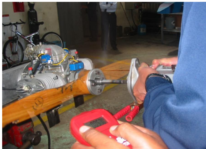
Figura 3.15 Prueba para medir las RPM del arrancador NIPPONDENSO y hélice empleada para el efecto
