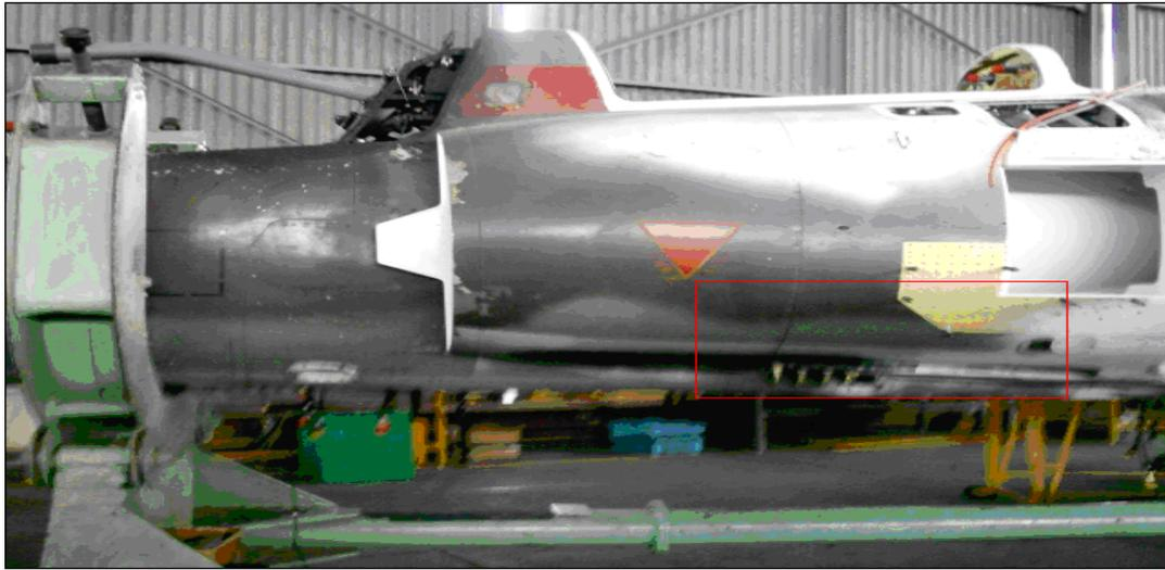
Figura 1.4. Vista lateral derecha del avión Kfir, ubicación de la turbina en el pozo de tren de nariz.
