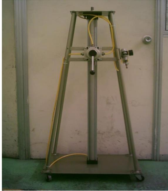
Figura 3.4. Ensamblaje de la estructura del soporte y el sistema neumático
