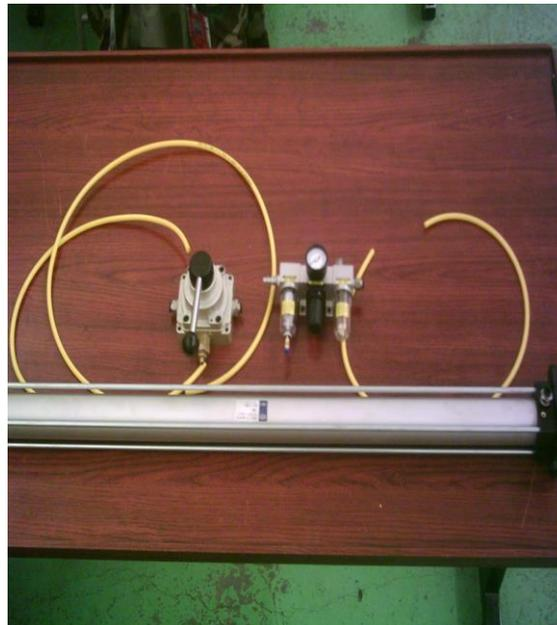
Figura 3.3. Componentes del sistema neumático del soporte.
