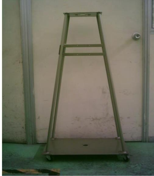
Figura 3.2. Vista frontal de la estructura del soporte de accionamiento neumático
