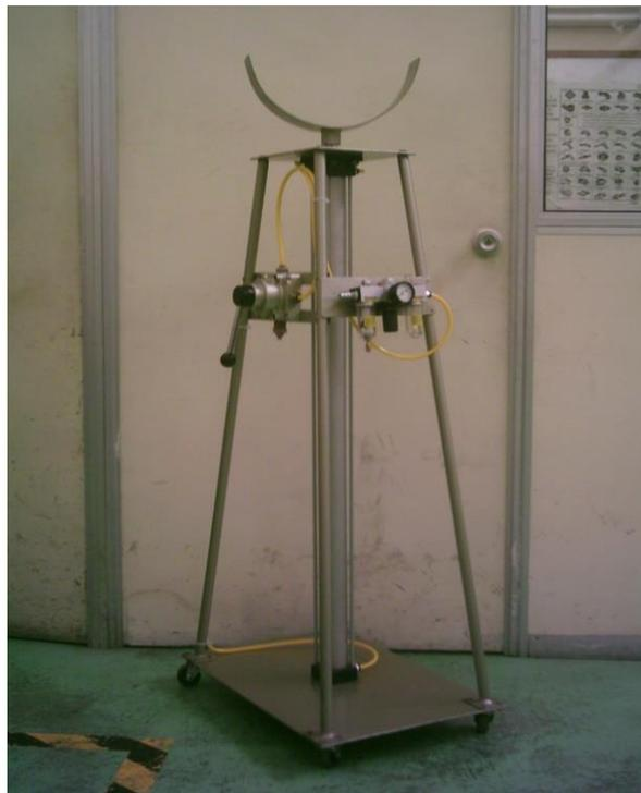
Figura 3.5. Ensamblaje de la estructura del soporte, el sistema neumático y la cuna para la turbina de enfriamiento
