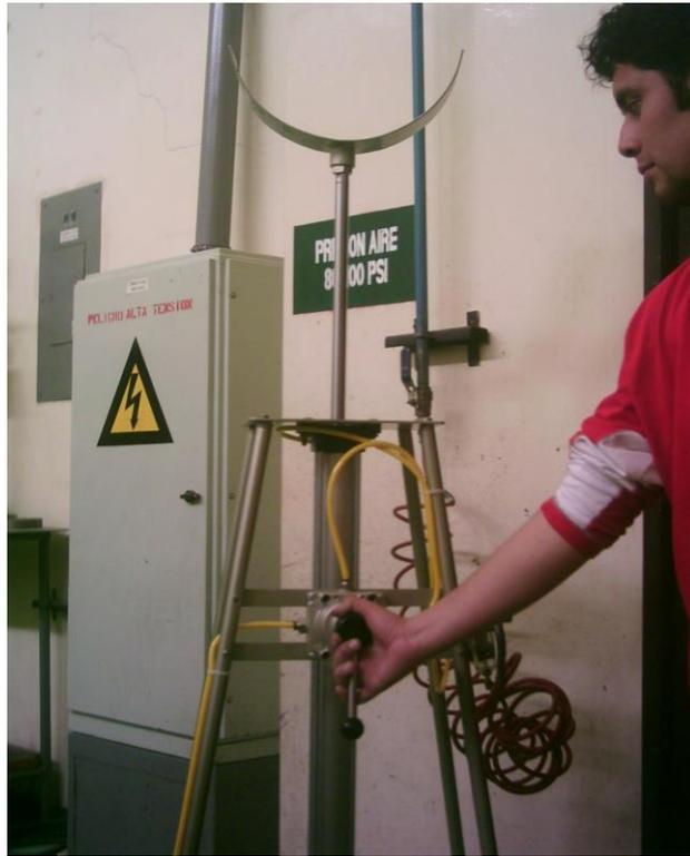
Figura 3.6. Prueba funcional del soporte de accionamiento neumático armado.
