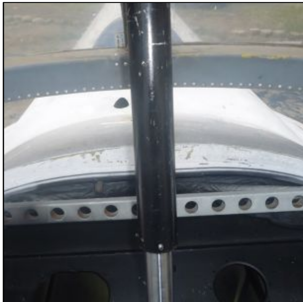
Figura 77: Extensión y vástago del actuador hidráulico acoplados
