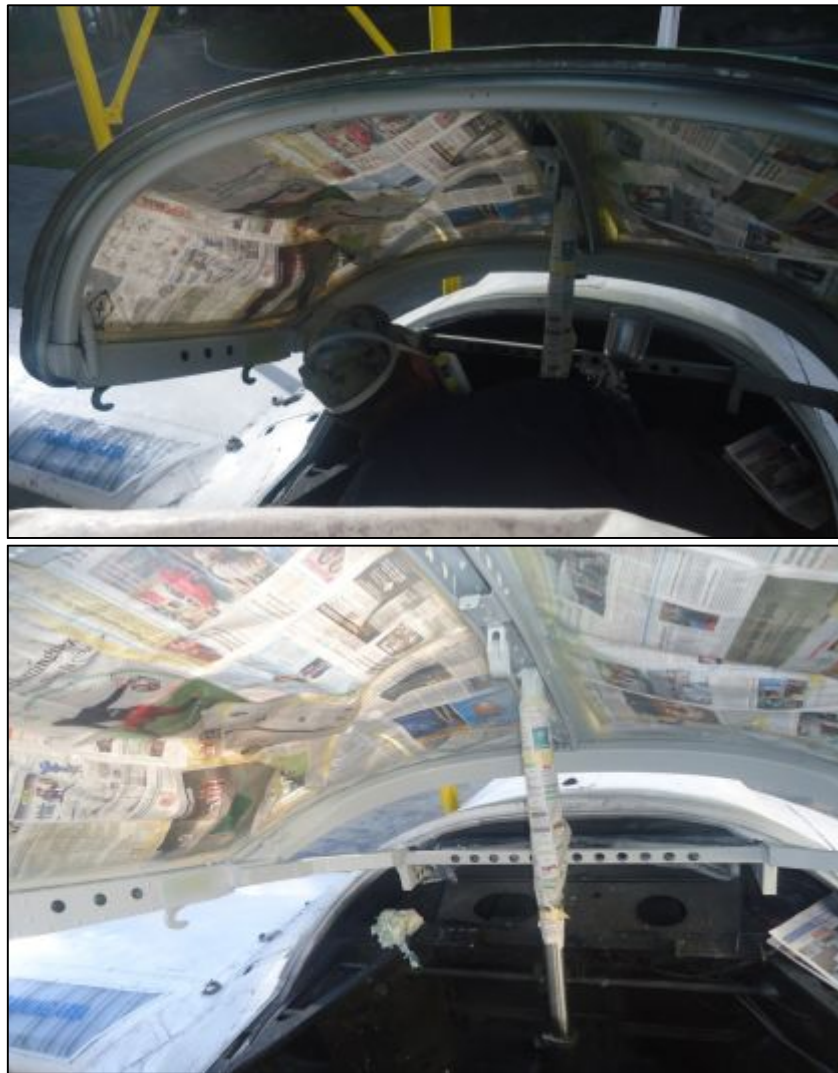
Figura 92: Aplicación de pintura color gris
