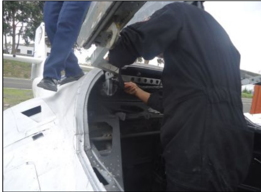
Figura 74: Ajuste de pernos de sujeción de Hinge Army
