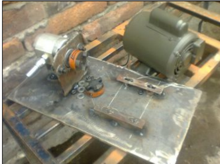
Figura 64: Base para el Motor y Bomba hidráulica
