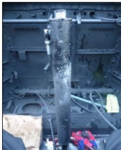
Figura 75: Actuador Hidráulico instalado en la cabina de la aeronave
