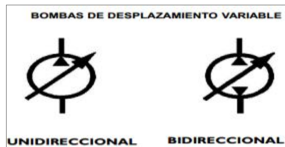
Figura 35: Símbolos de Bomba de Desplazamiento Variable.
