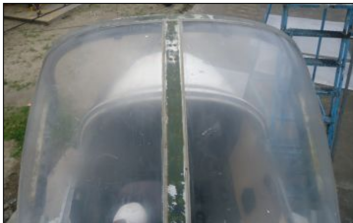
Figura 83: Cristal del canopy antes de pulir
