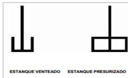
Figura 28: Estanque venteado y presurizado
