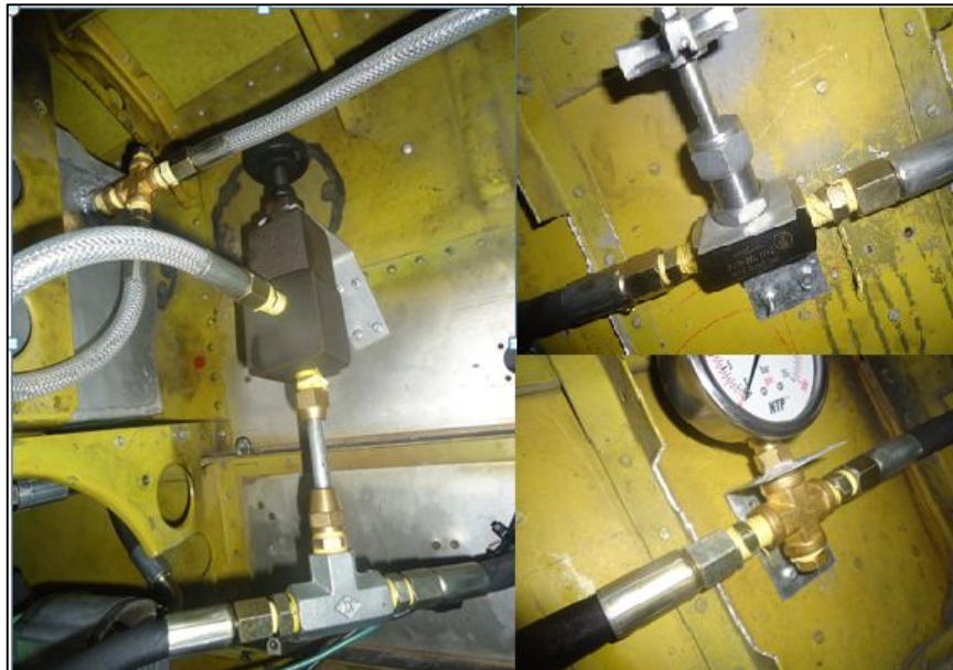
Figura 81: Cañerías y acoples ajustados
