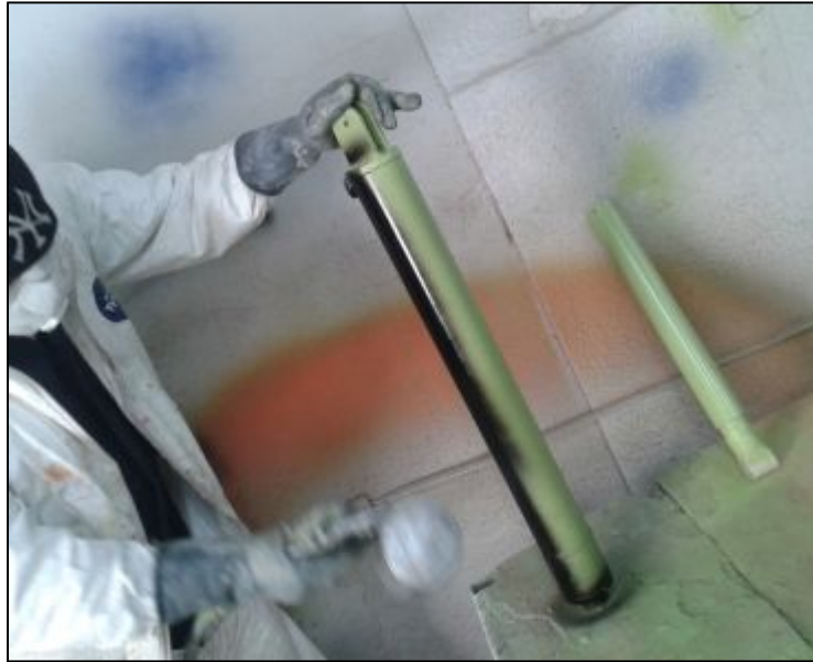
Figura 60: Proceso de pintura del actuador
