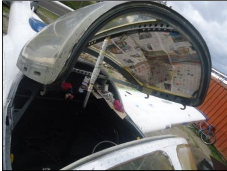
Figura 90: Estructura del canopy enmascarado
