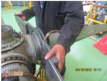
Herramienta especial para remover las palas (TL4488).
