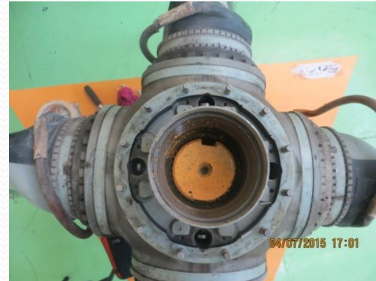
Remoción de Alojamiento de Anillo Deslizantes.
