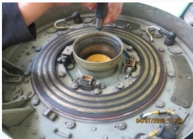
Remoción de los Switches de Contacto y Tapón de Balance.
