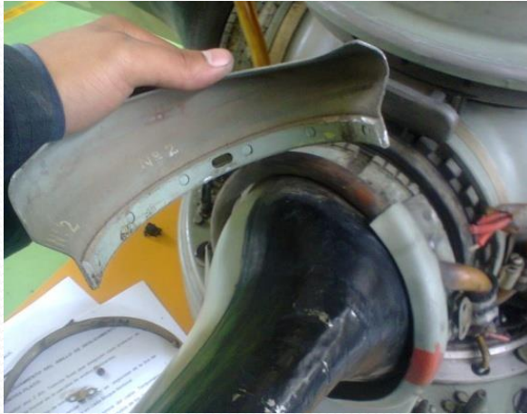
Desmontaje del Blindaje de las Palas.
