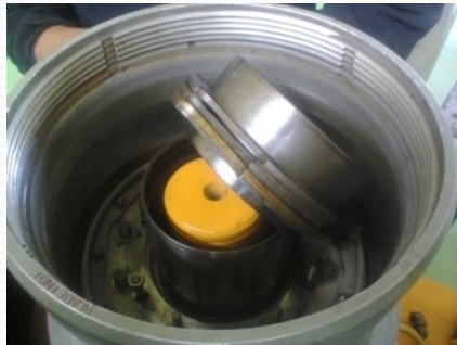
Remoción de la Parada de paso Fino de Crucero, Vuelo y Camisa del Pistón.
