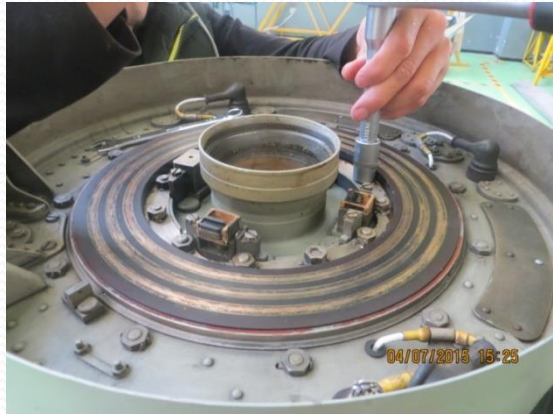
Alojamiento del Anillo de Deslizamiento.
