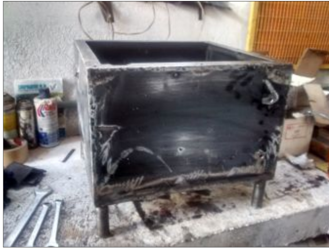
Figura 94 Lijado del reservorio.
