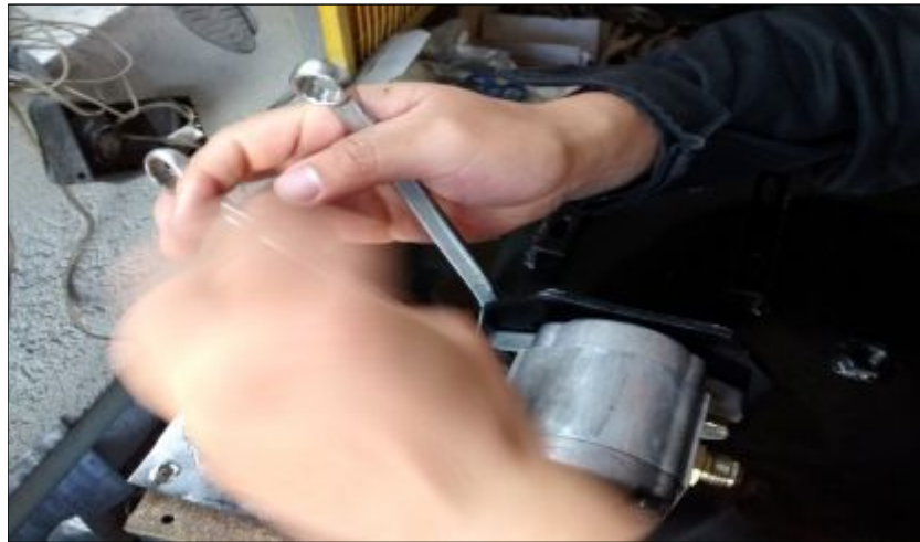
Figura 98 Montaje de la bomba hidráulica.
