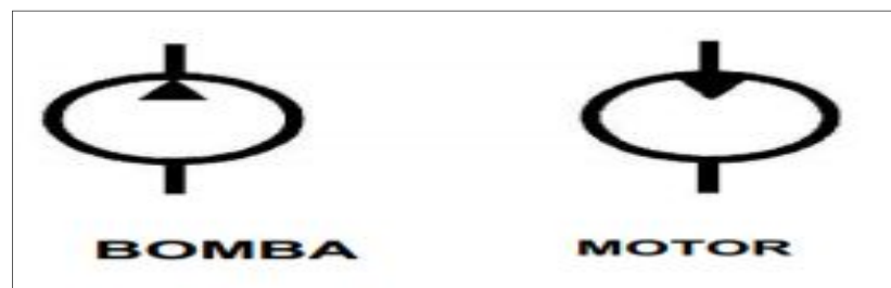
Figura 24 Simbología Bomba Y Motor
