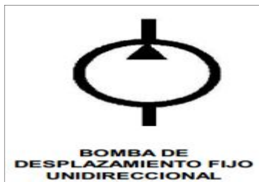
Figura 25 Símbolo de Bomba de Desplazamiento Fijo unidireccional.
