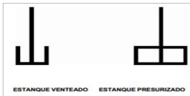
Figura 20 Estanque venteado y presurizado
