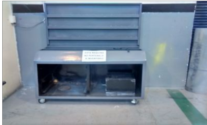
Figura 82 Banco hidráulico (Estructura)
