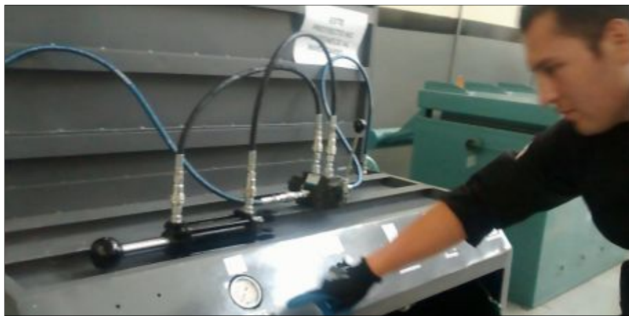
Figura 105 Verificación de fugas en el sistema.
