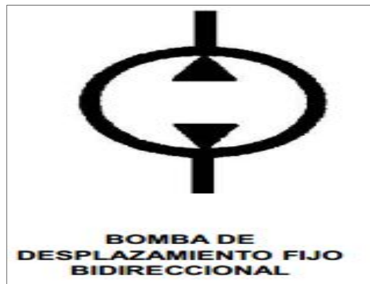
Figura 26 Símbolo de Bomba de Desplazamiento fijo bidireccional.
