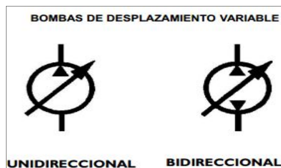
Figura 27 Símbolos de Bomba de Desplazamiento Variable.
