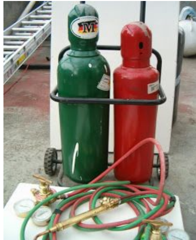
Figura 2.17: Soldadura por fusión
