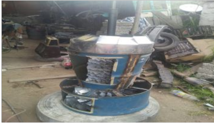
Figura 3.10: Ensamble Cámara de combustión
