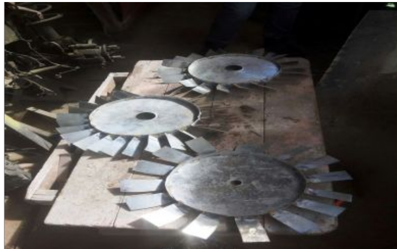
Figura 3.4: Compressor de alta
