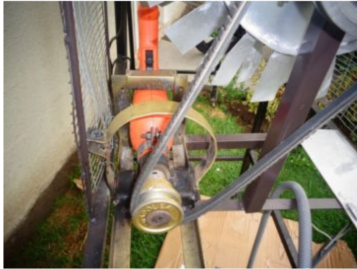
Figura 3.15: Motor de Taladro AC y sistema de Poleas
