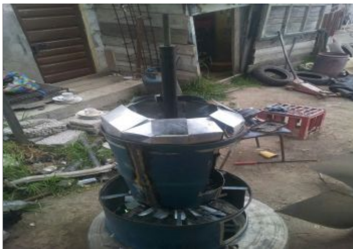
Figura 3.9 Ensamble Cámara de combustión
