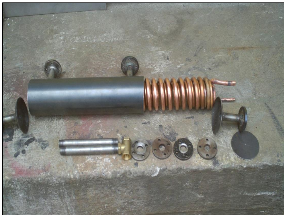
Figura 3.6 Partes del intercambiador de calor de coraza y doble serpentín
