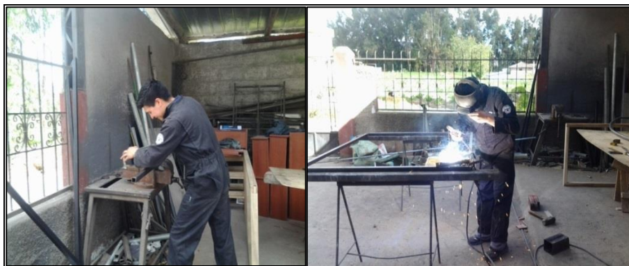
Figura 3.14 Proceso de corte y suelda del esqueleto de la maqueta
