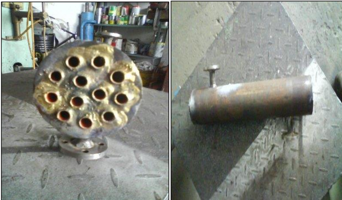
Figura 3.2 Construcción del intercambiador de calor (coraza y tubo)
