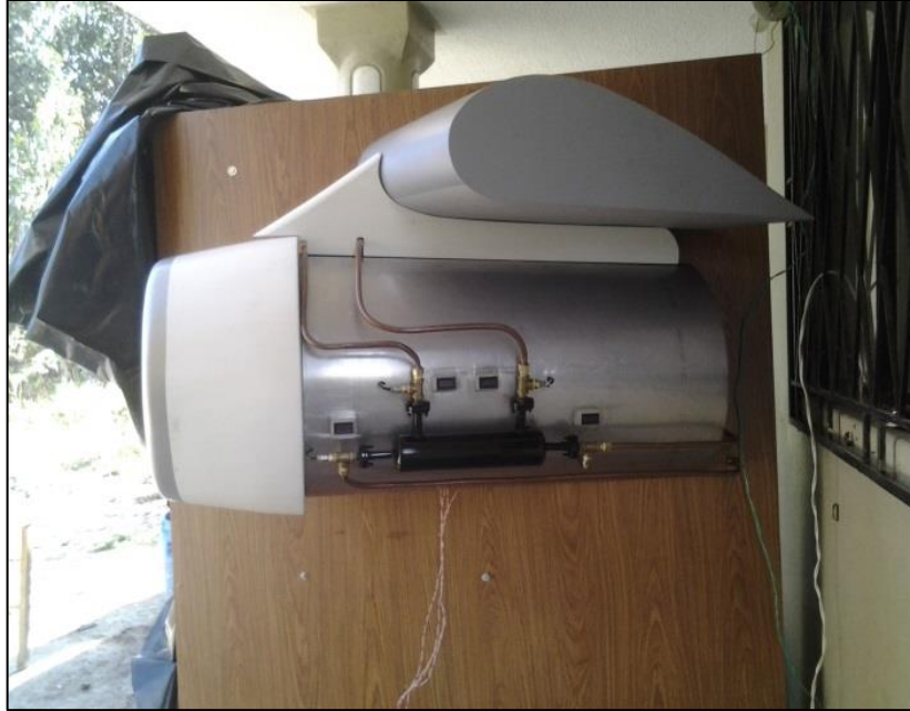
Figura 3.27 Instalación del fuel/oil cooler y termómetros
