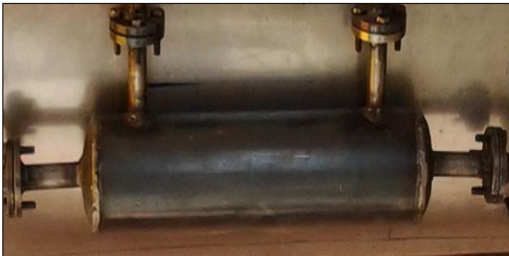
Figura 3.7 Intercambiador de calor de coraza y doble serpentín terminado
