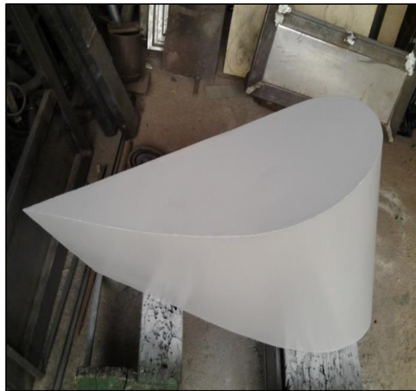
Figura 3.23 Acabado final del perfil alar
