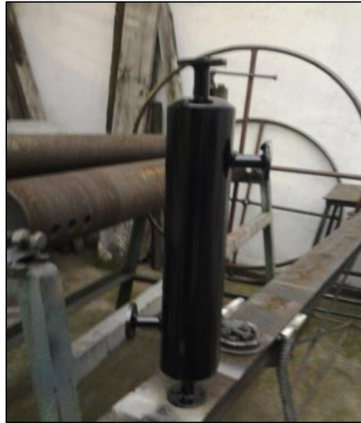
Figura 3.3 Acabado final del intercambiador de calor
