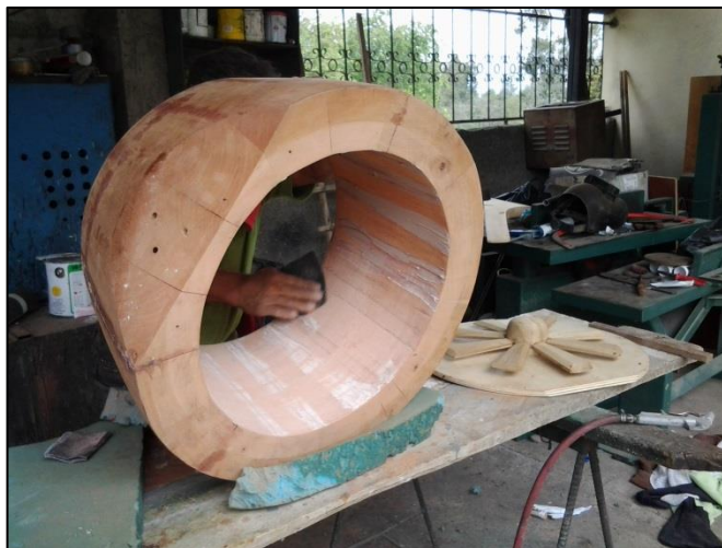
Figura 3.20 Proceso de masillado y lijado
