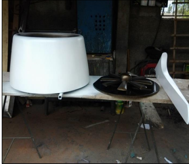
Figura 3.22 Acabado final de pintura del cowling del motor y pylon
