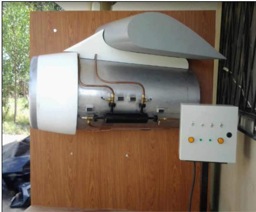
Figura 3.33 Instalación de la caja de control
