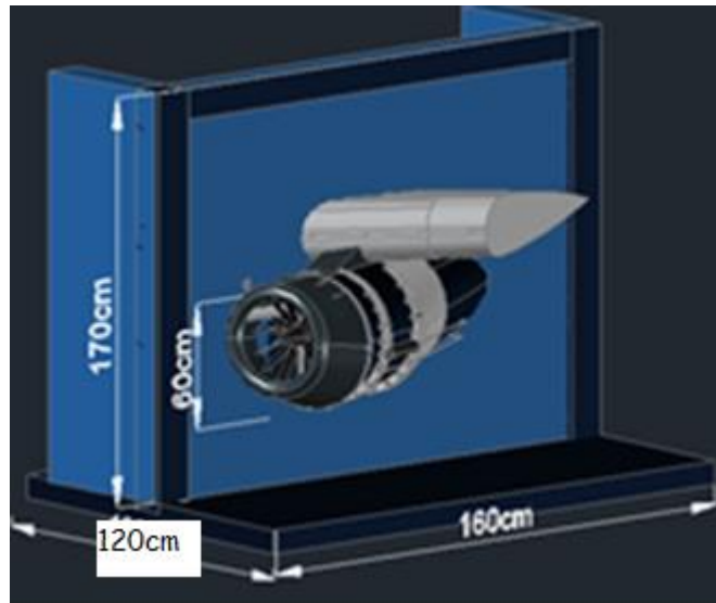
Figura 3.13 Vista lateral de la maqueta
