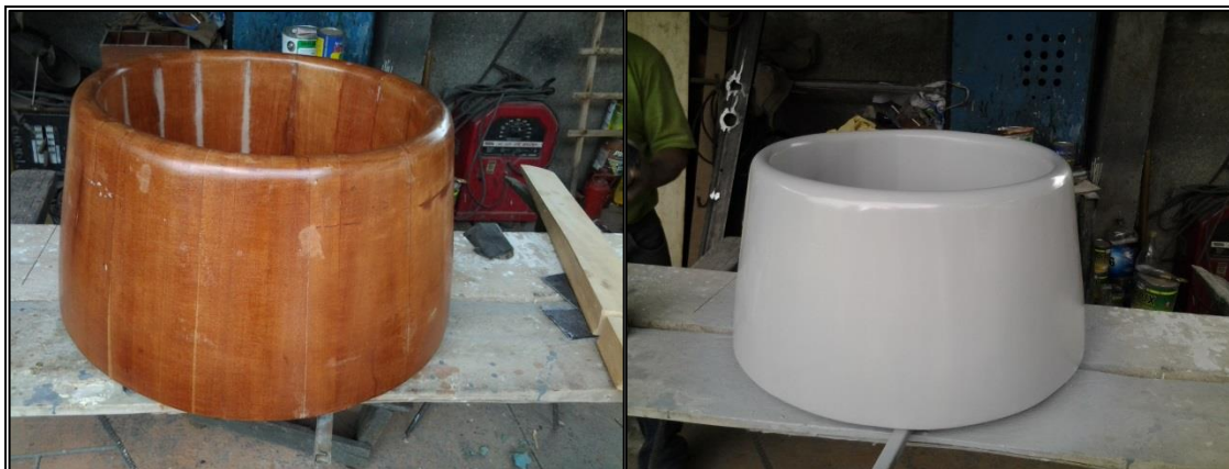
Figura 3.21 Proceso de sellado y fondo del cowling
