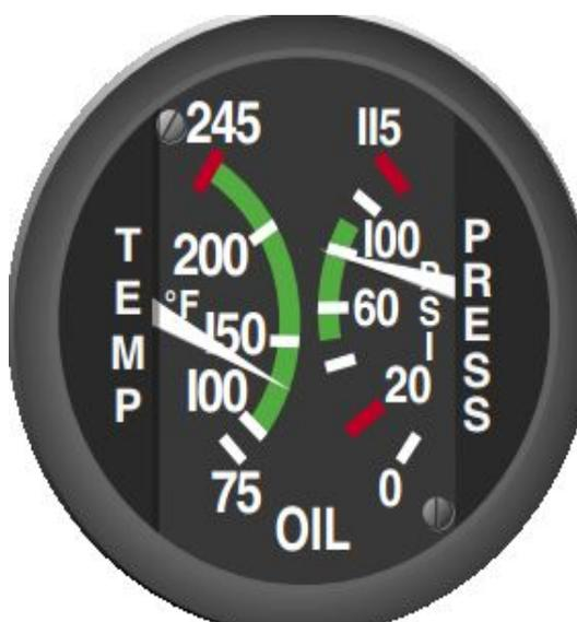
**Figura 12. Indicador del sistema de lubricación.**
