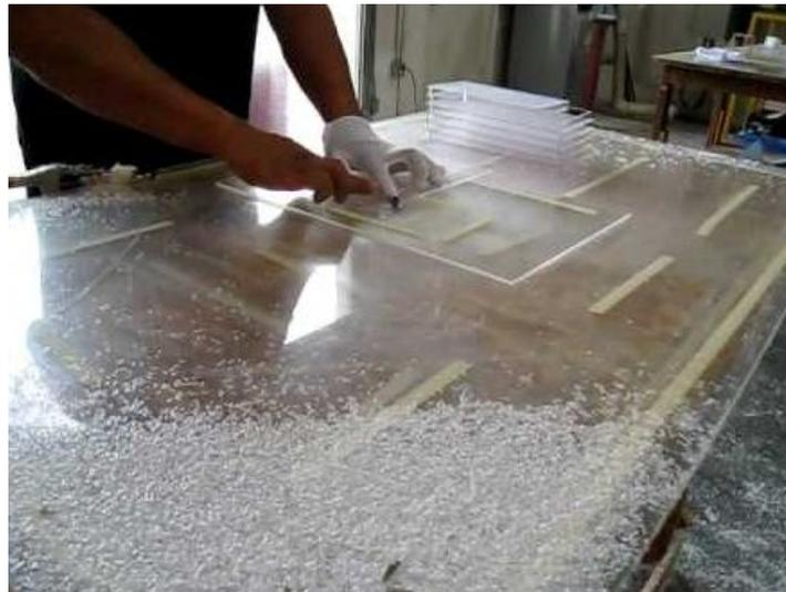
**Figura 33. Corte del acrílico de forma artesanal.**
