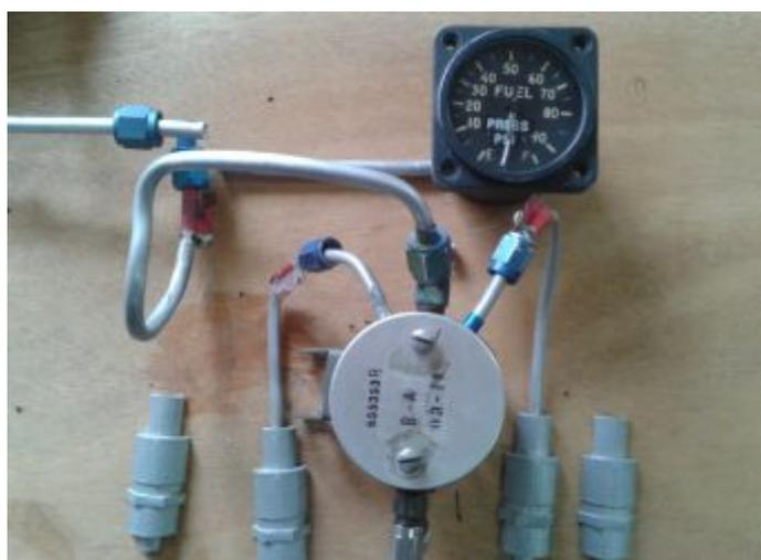
**Figura 38. Ensamble de los inyectores impresos en 3D**
