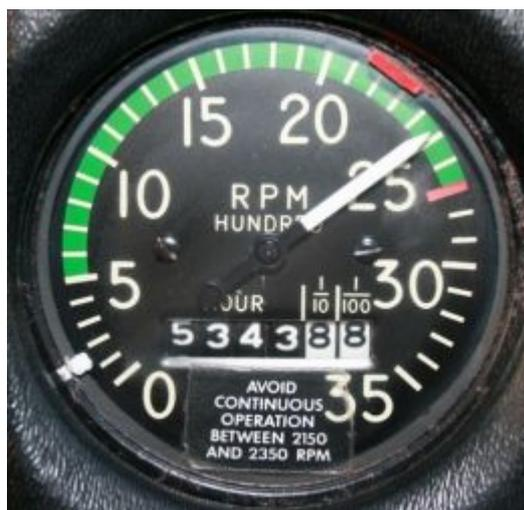
**Figura 8. Indicador de RPM típico de motor recíproco.**
