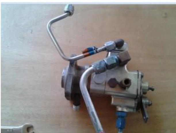
**Figura 30. Ensamble de las líneas a la bomba.**
