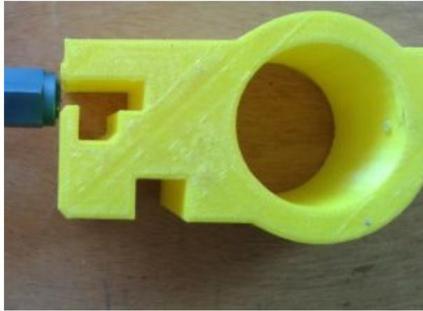
**Figura 32. Resultado de la impresión del THROTTLE ASSEMBLY**
