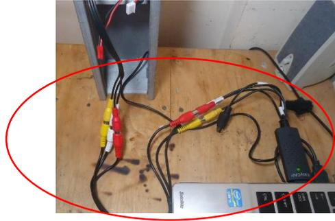
11. En la Ground Station, conecte la entrada de energía de la batería al receptor de video (DC IN).
