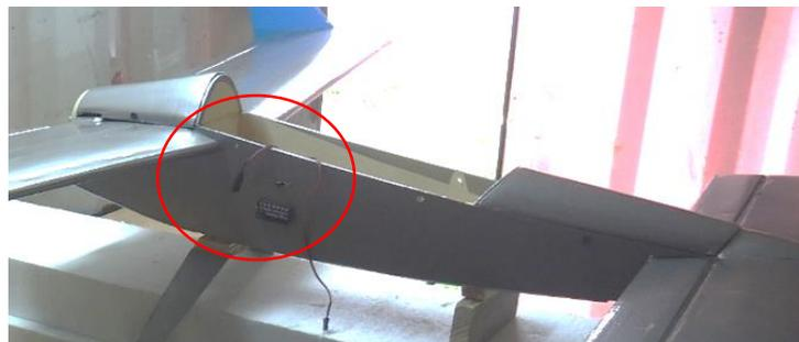
15. Compruebe que todos los servomotores responden al mando de la estación, moviendo los sticks del radio-mando.
