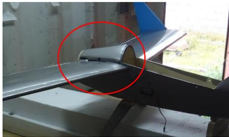
5. Una vez llenado el tanque de combustible con nitrometano, proceda a cerrar la lid de electrónica con los tornillos de sujeción.
