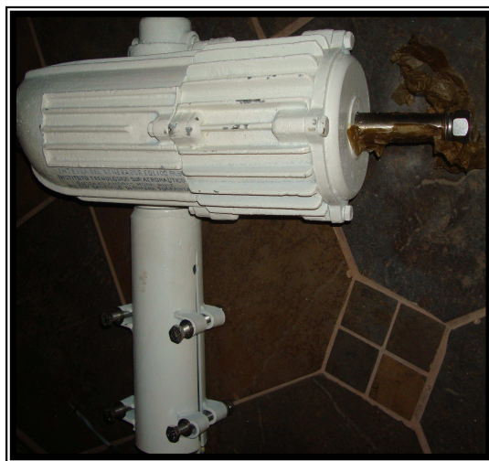
Fotos 3.3.1.7 Conjunto del generador cubierto con su góndola
