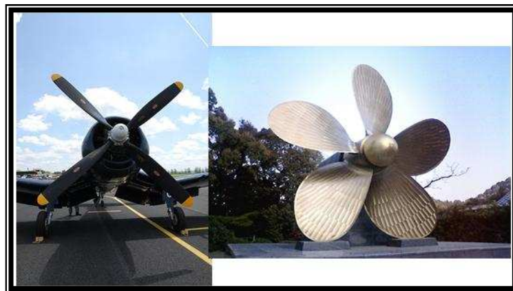
Figura 2.9.4.1 Tipos de palas según el fluido Fuente: http://es.wikipedia.org/wiki/Archivo:F4U_Corsair_(engine)_-_AirExpo_Muret_2007_0184_2007-05-12.jpg -- http://es.wikipedia.org/wiki/Archivo:Screw-Konpira.jpg Realizado por: Mora Gustavo
