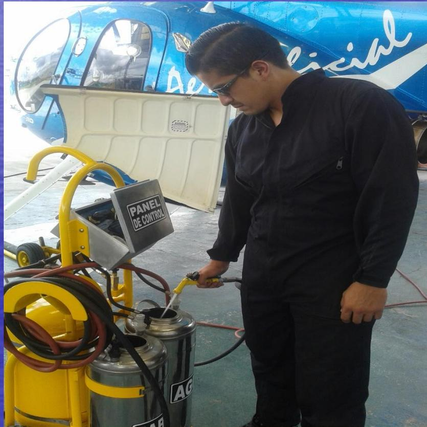
Colocar la manguera de desfogue en el acople del motor.
