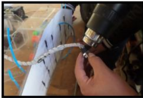
Figura 49. Calor a los espaguetis por medio de una pistola de calor
