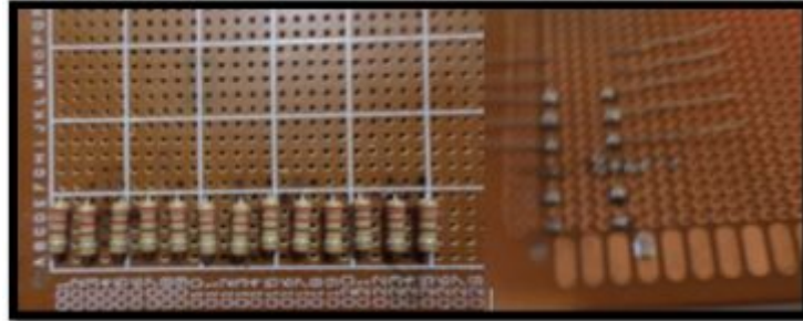
Figura 46. Resultado Esperado sobre Soldadura de Resistencias
