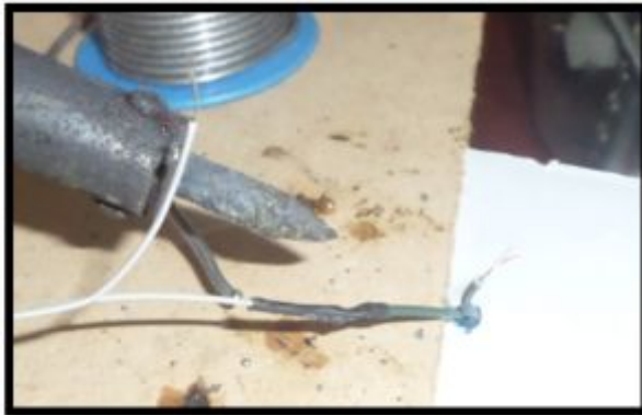
Figura 41. Circuito protegido por espaguete
