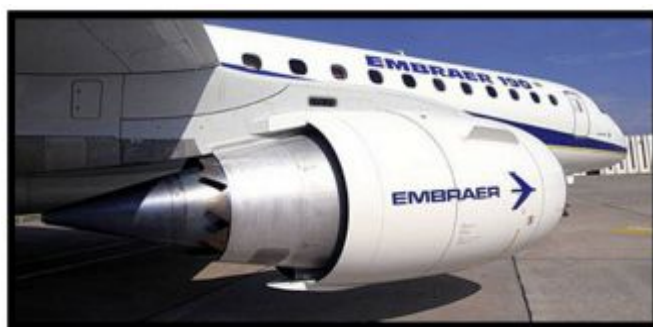
Figura 6. Motor CF34E de los aviones Embraer 170-190 Fuente: (embraer.com, 2005)
