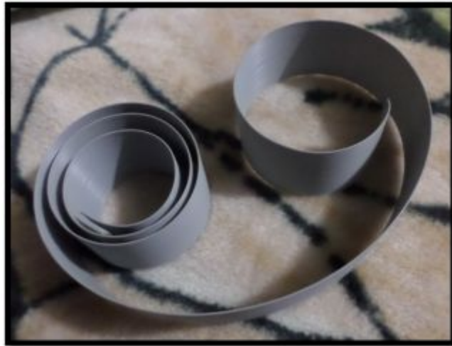
Figura 38. Cableado de 40 pines
