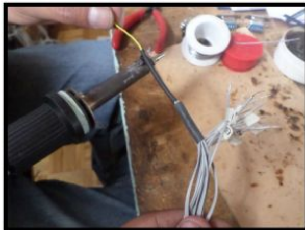
Figura 47. Soldado de cables negativos
