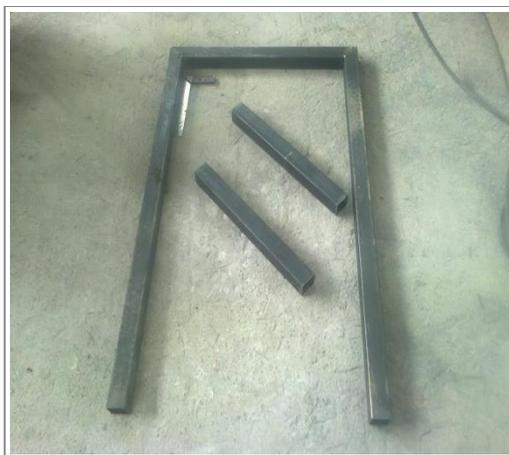
**Figura 37** Corte del perfil
