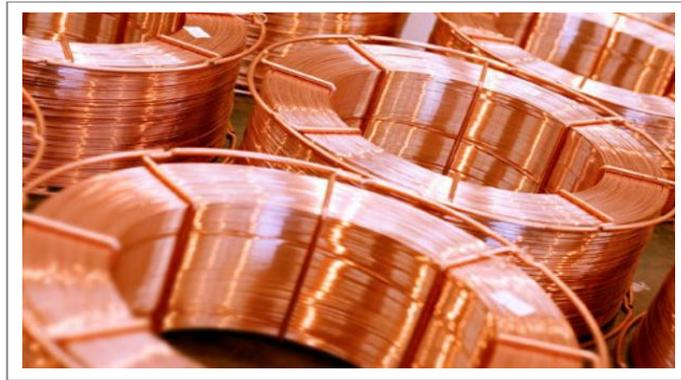
**Figura 26** Hilos electrodos MIG
