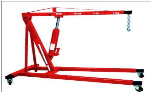
**Figura 6** Tecle hidráulico
