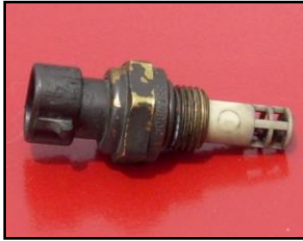
Figura 3.6 Sensor de temperatura del múltiple de admisión.
