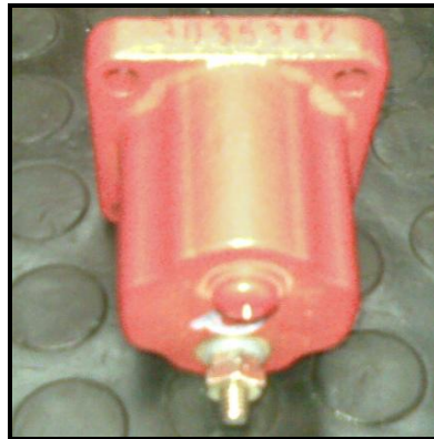
Figura 3.26 Solenoide de cierre de combustible.
