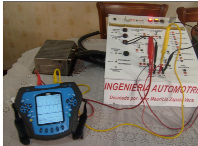
Figura 4.1 Instalación del osciloscopio a cada elemento
