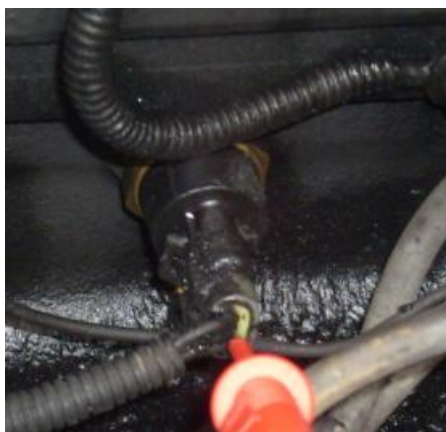
Figura 3.22 Sensor de temperatura del motor WTS
