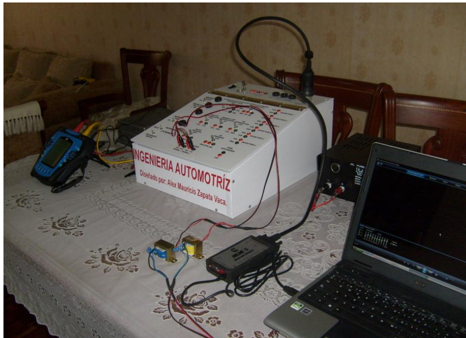
Figura 4.40 Conexión del interfaz INLINE al simulador.
