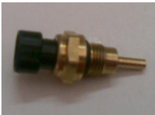
Figura 3.15 Sensor de temperatura del motor WTS
