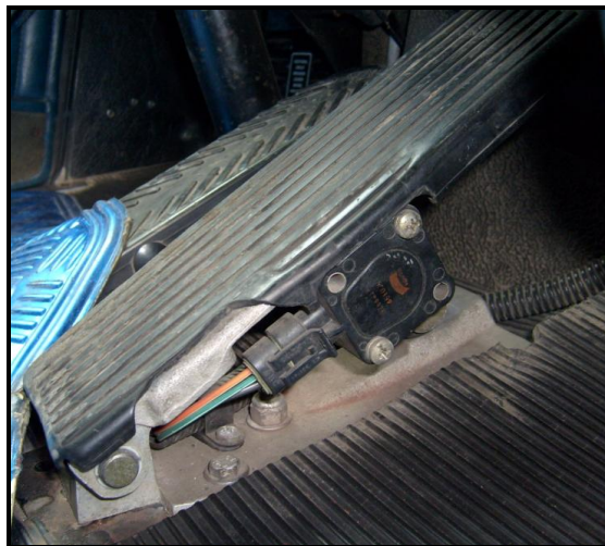
Figura 3.29 Sensor de posición del acelerador (TPS)
