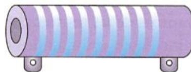
Figura 1.3 Resistencia bobinada de gran potencia 10W en adelante
