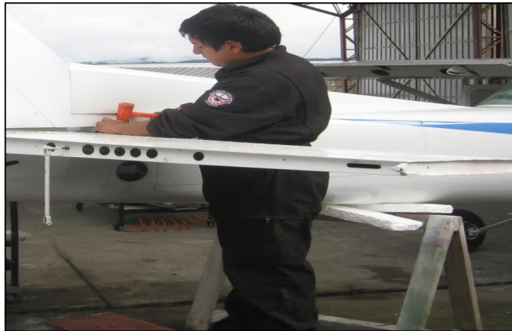
Figura 64. Instalación del estabilizador vertical
