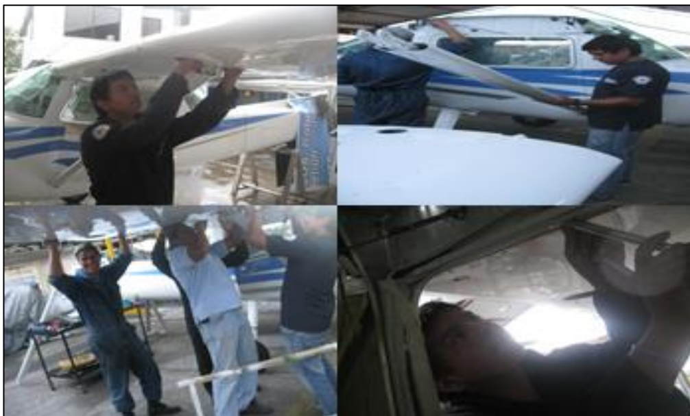
Figura 56. Montaje de alas, Struts
