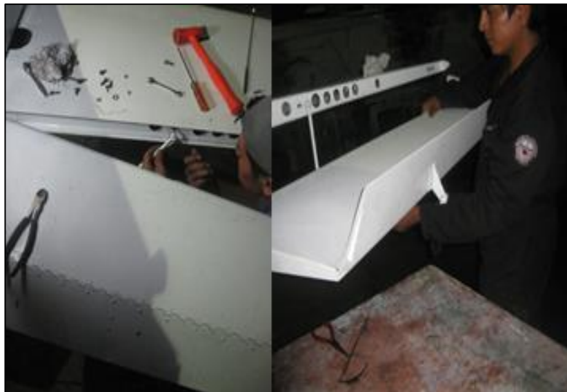
Figura 65. Colocación del elevador
