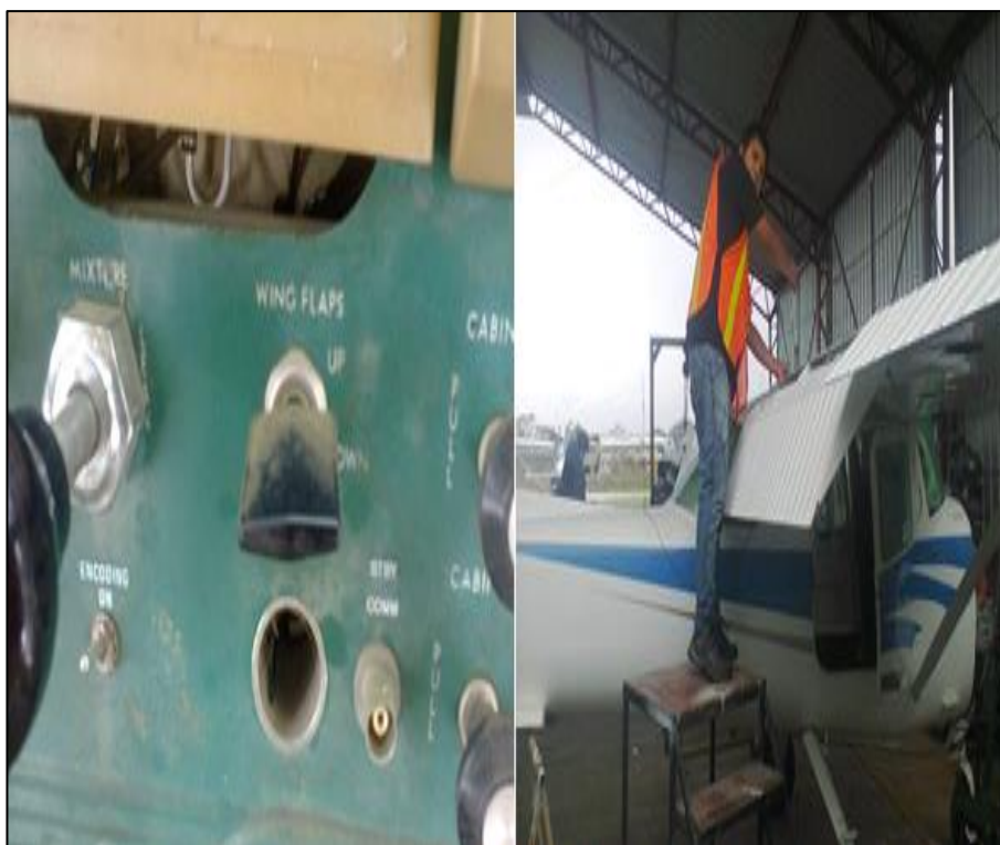
Figura 62. Reglaje de los flaps
