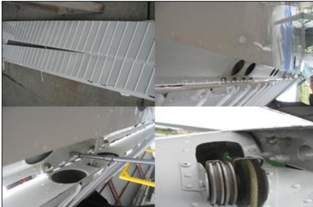
Figura 58. Instalación de los alerones
