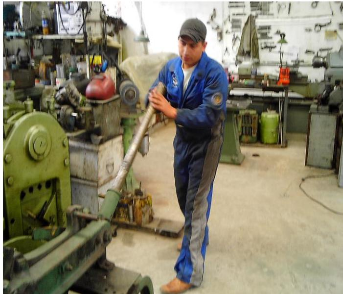
Fig. 2.2 Cizalla manual de corte.
