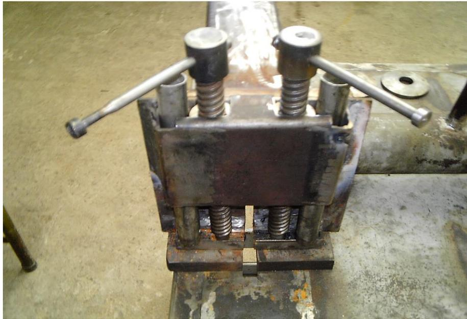
**Foto N° 3 construcción de los pernos de sujeción**
