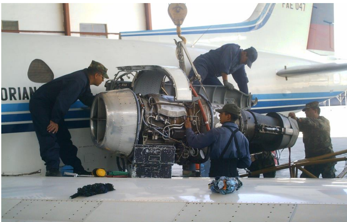
Figura 2.18: Normas de seguridad de los técnicos al bajar un motor.
