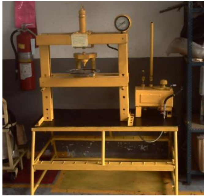
Figura 5.37: Prensa hidráulica armada y terminada.
