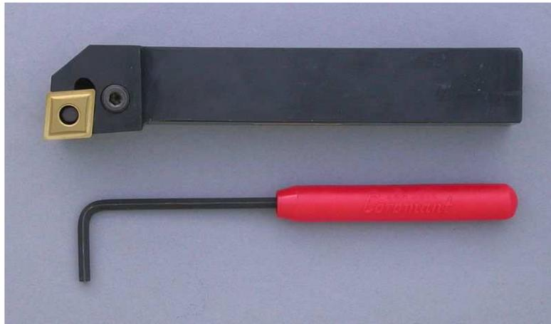
Figura 2.23. Herramienta de torneado exterior
