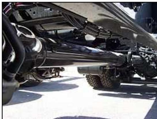
Figura 2.30.Eje de transmisión de un camión
