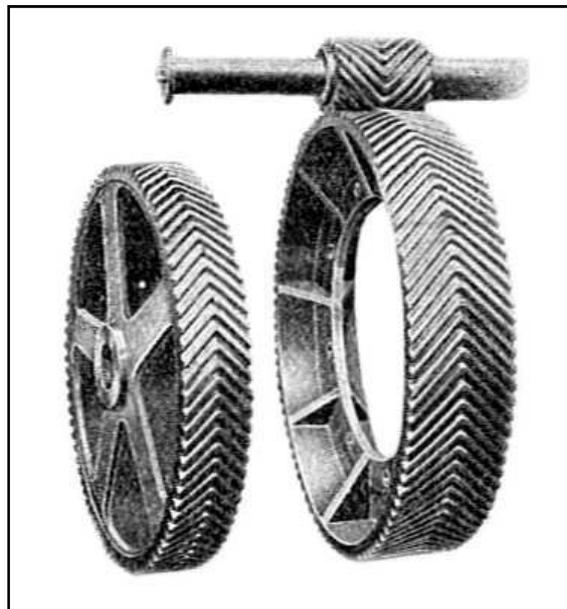
Figura 2.8. Engranajes helicoidales dobles
