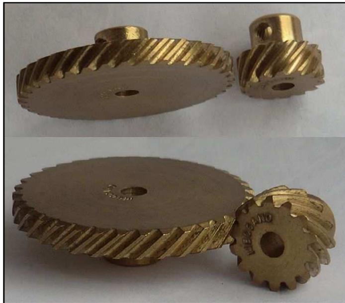
Figura 2.7. Juego de engranajes helicoidales
