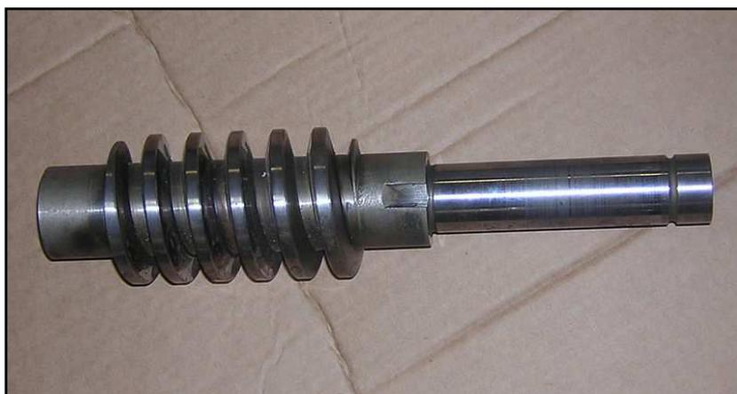
Figura 2.11. Tornillo sin fin de montacargas
