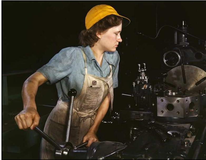
Figura 2.19. Operaria manejando un torno revolver
