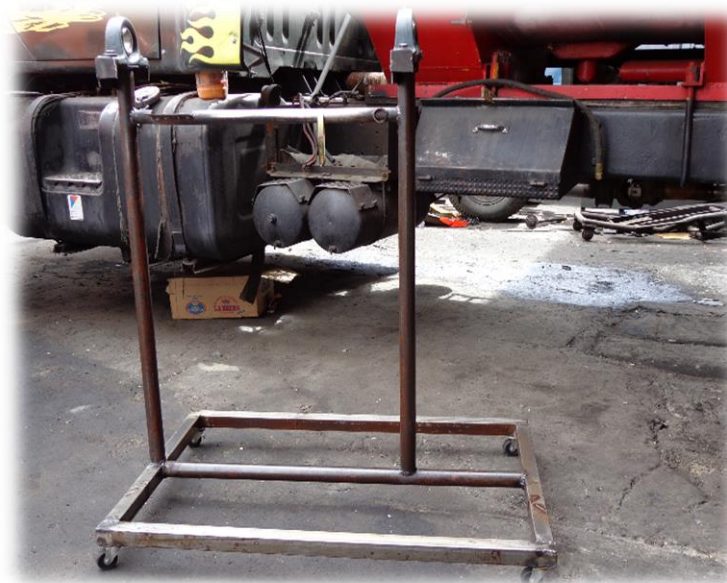
Fig. 3.10: Soldada de soporte vertical.
