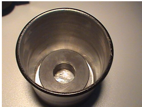
Fotografía 10: Se producen aberraciones y dispersiones por la ubicación de la matriz en el fondo del recipiente
