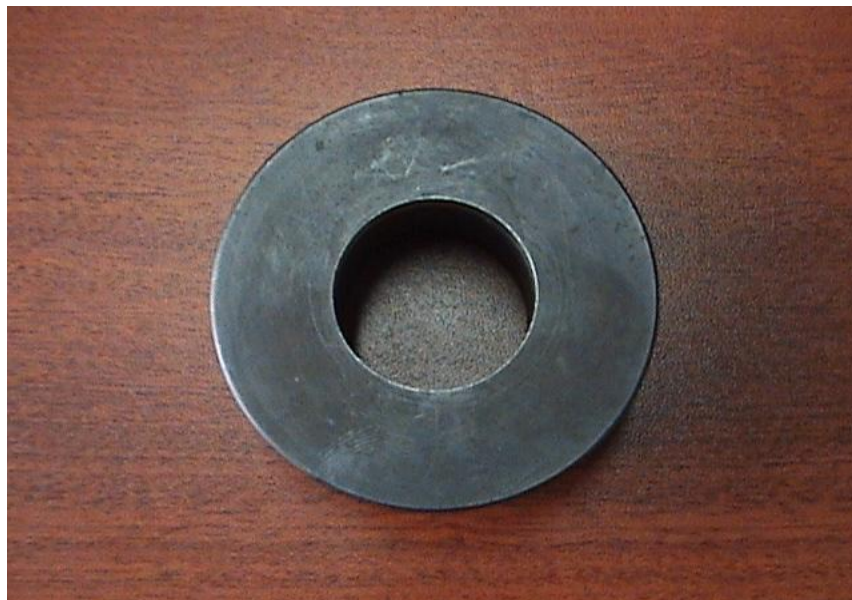
Fotografía1 Matriz de corte construida en acero K100
