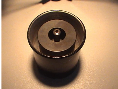
Fotografía 9 Montaje adecuado para el tratamiento térmico de punzones y matrices
