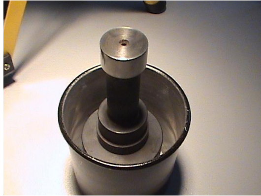
Fotografía 11: En este montaje matriz-recipiente, producen pérdidas por de calor por convección y radiación
