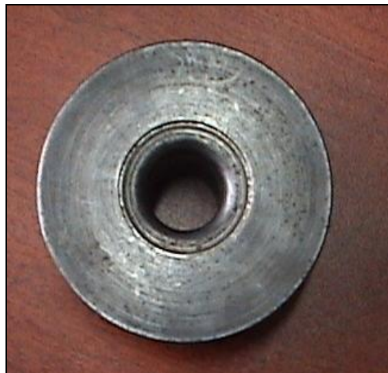
Fotografía 4 Matriz de embutición en acero Bohler K460
