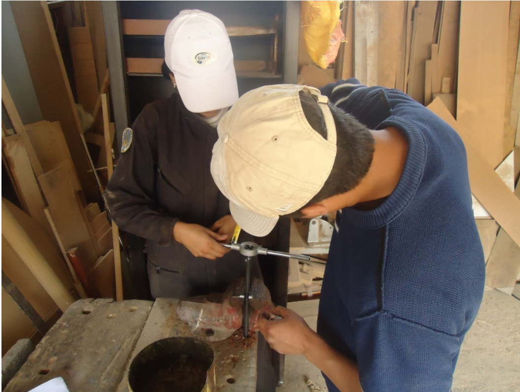
Figura 69. Fabricación de pernos Fuente: Pablo Herrera
