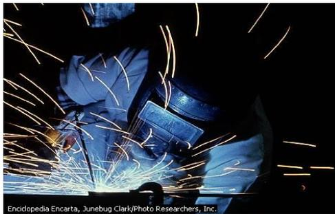
**Fig. 12 Soldadura por Arco**
