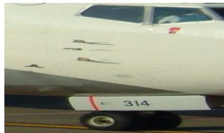
FIG. 3 Ubicación del Tubo Pitot Estático
