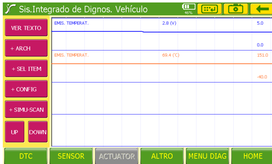
Figura 4.44. Curva 1 en el osciloscopio del sensor ECT.
