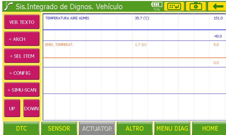
Figura 4.40. Curva 1 en el osciloscopio del sensor IAT.
