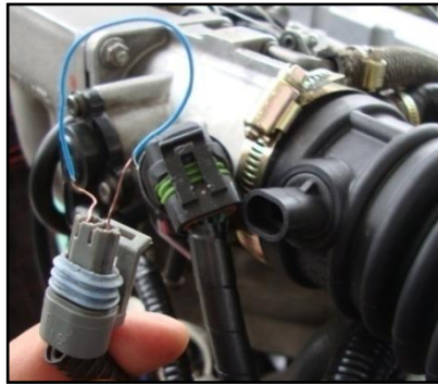
Figura 4.78. Puente en el socket del IAT.
