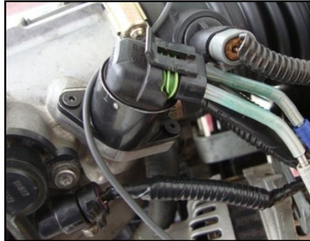
Figura 4.99. Desconexión, remoción de la IAC.
