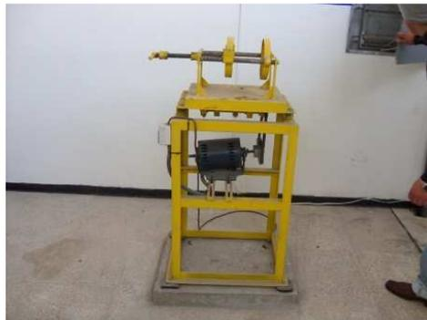
Figura 4.37 Agitador montado
