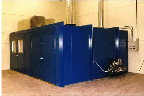
Figura 2.4 Cabina presurizada de filtro seco
