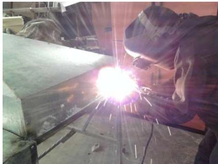
Figura 4.6 Soldadura de la platina
