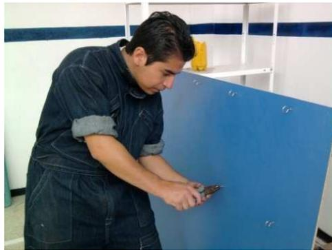
Figura 4.50 Colocación de cáncamos
