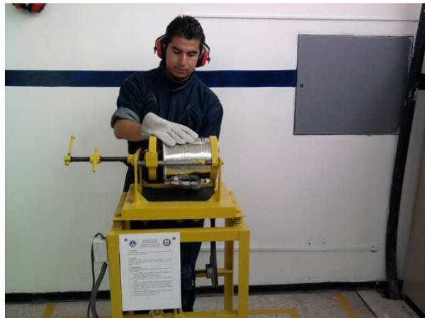
Figura 6.3 Colocación del recipiente de pintura
