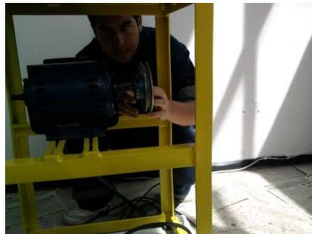
Figura 4.43 Banda de conexión de ejes
