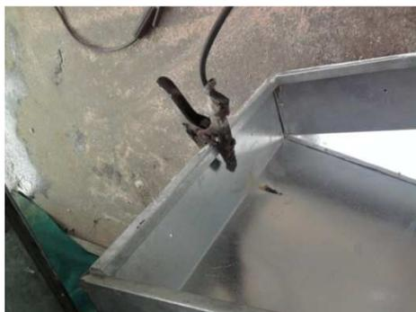
Figura 4.7 Conexión a tierra
