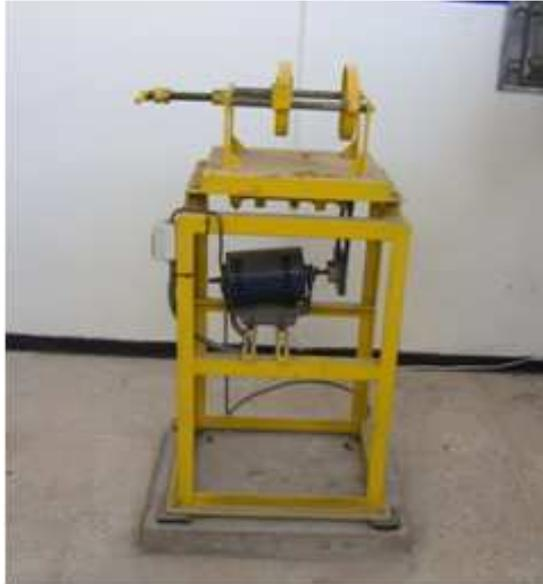
Figura 4.2 Agitador de pintura
