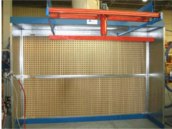
Figura 2.2 Cabina de pintura de filtros secos modulares
