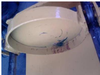
Figura 3.10 Corrosión agitador de pintura
