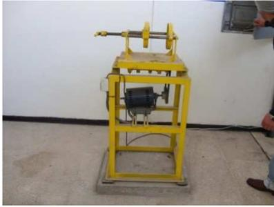
Figura 3.11 Agitador de pintura
