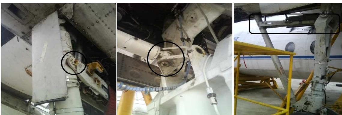
**Figura N.- 59** Lock Strut colocado y asegurado
