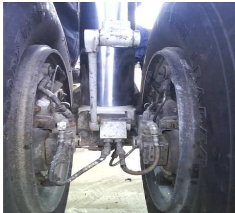
**Figura N.- 35** Sistema óleo-neumático del tren de avión Fairchild ubicado en el ITSA
