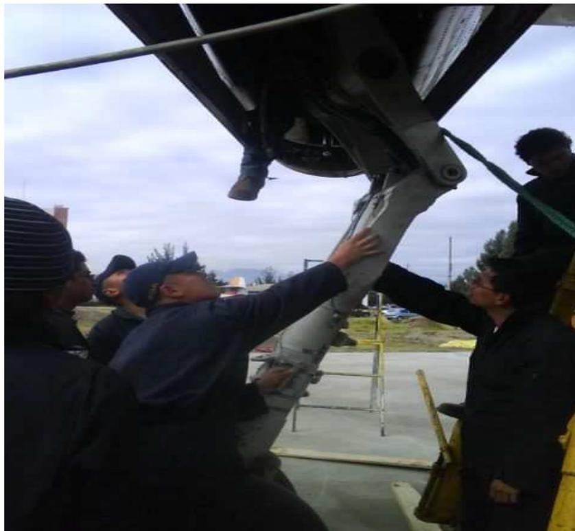
**Figura N.-49** Colocación del tren en el lugar indicado
