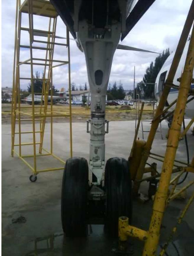
**Figura N.- 34** Sistema de amortiguación del avión Fairchild ubicado en el ITSA
