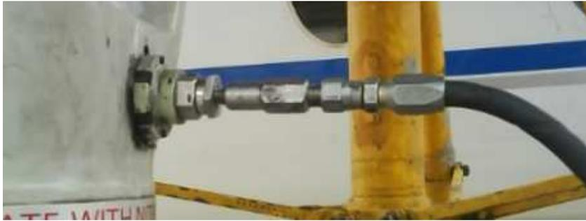
**Figura N.- 73** Conexión para el suministro de nitrógeno
