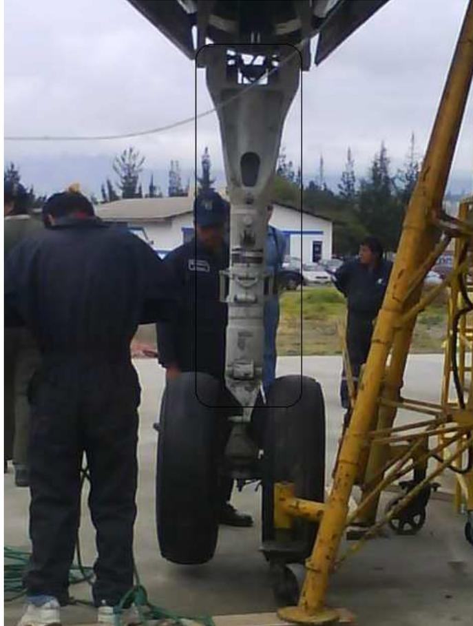
**Figura N.- 40** Shock strut durante el montaje del tren
