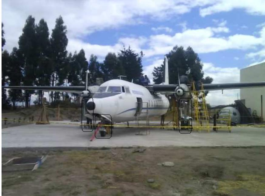
**Figura N.-24** Tren tipo triciclo del avión Fairchild ubicado en el ITSA
