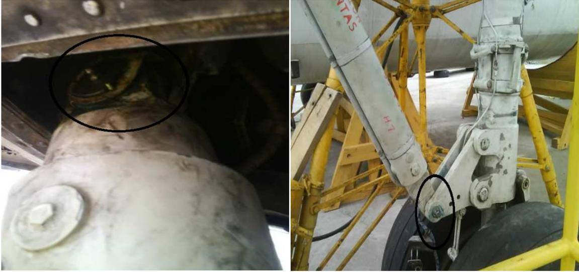
**Figura N.- 57** Drag Strut instalado y sujetado en los dos extremos
