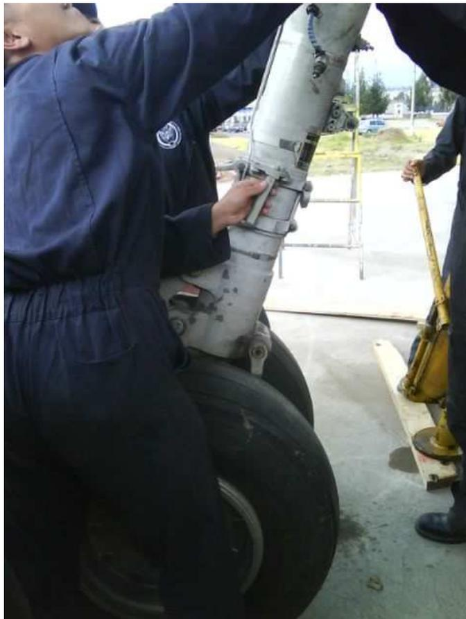
**Figura N.- 53** Elevacion del Shock Strut para el montaje
