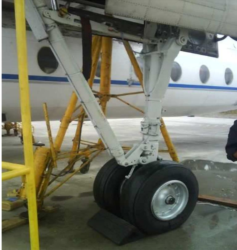
**Figura N.- 69** Tren de aterrizaje limpio y listo para ser engrasado
