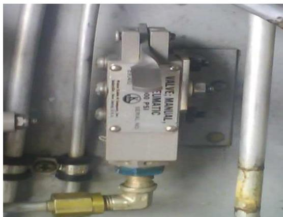
**Figura N.- 67** Válvula manual neumática
