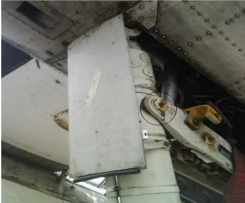
**Figura N.- 60** Extremo delantero del Lock Strut asegurado con pin y roscado en su extremo
