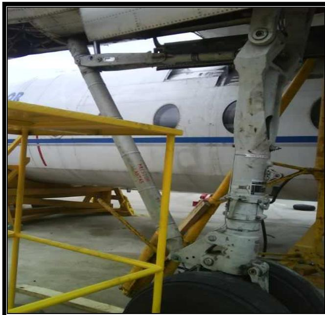
**Figura Anexo B:** Tren de aterrizaje principal izquierdo instalado en el ITSA
