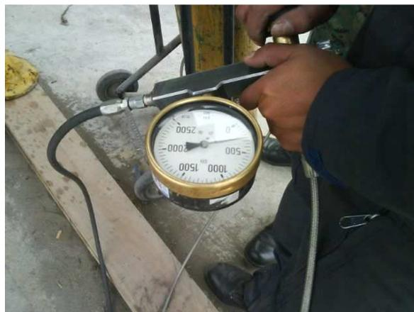
**Figura N.- 74** Manómetro que indica la cantidad de presión aplicada al tren
