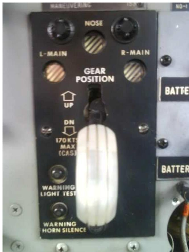
**Figura N.- 30** Mando e indicadores del tren retráctil del avión Fairchild ubicado en el ITSA
