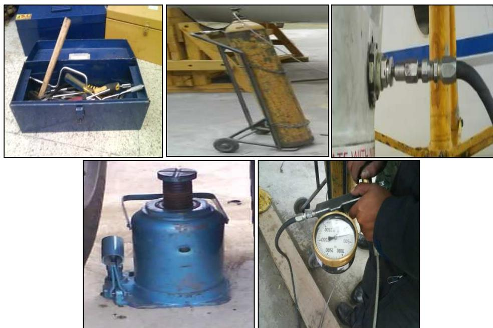
**Figura N.- 72** Herramientas necesarias para el procedimiento de servicio de nitrógeno
