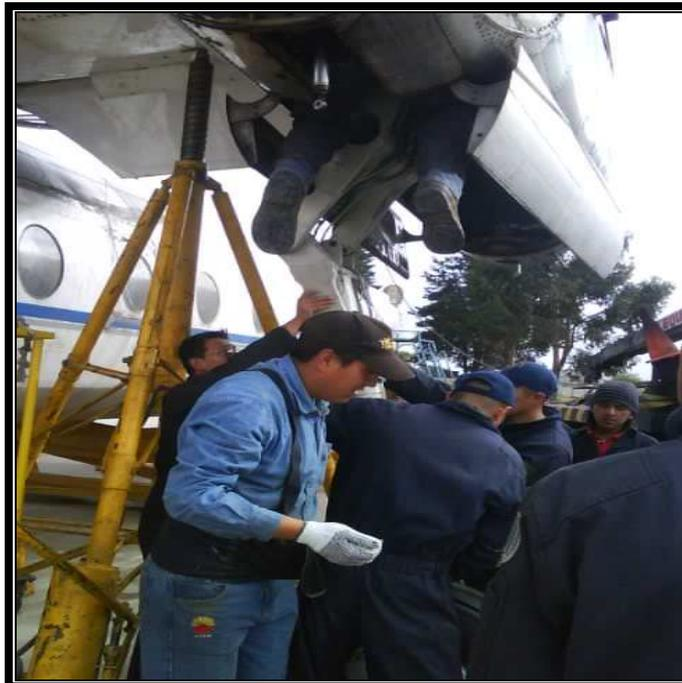
**Figura Anexo B:** Colocación del tren en el lugar indicado para el montaje.
