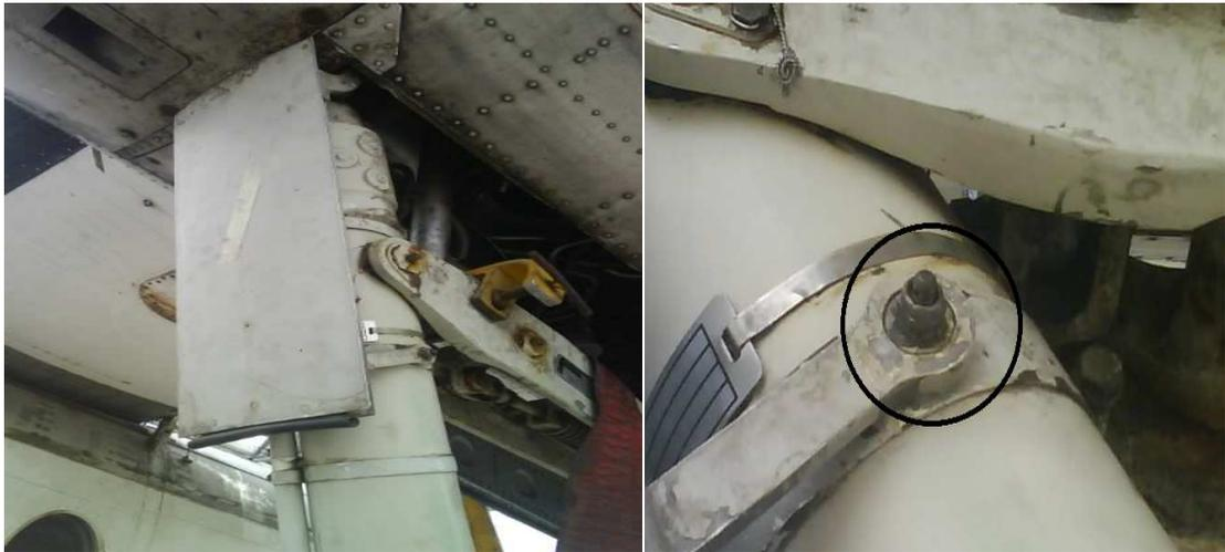
**Figura N.- 58** Puerta conectada y asegurada al Strut
