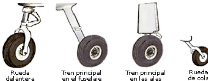
**Figura N.-27** Tipología del tren principal y ruedas direccionales
