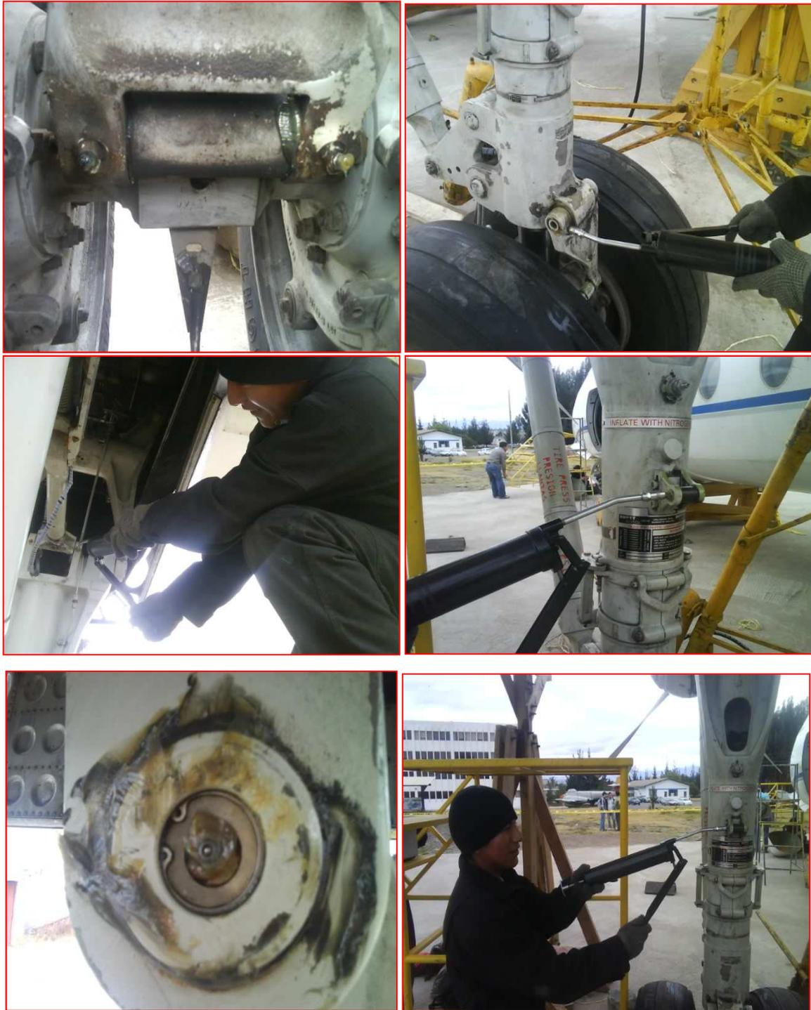
**Figura N.- 71** Proceso de lubricación en distintos puntos del tren
