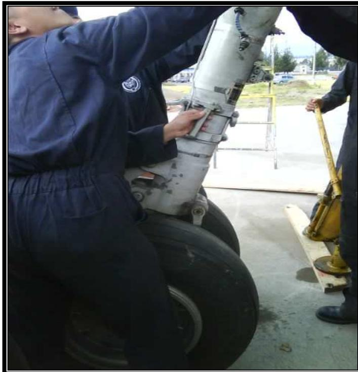
**Figura Anexo B:** Elevación del Shock Strut para el montaje.
