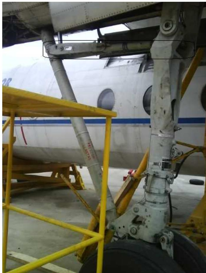
**Figura N.- 42** Lock Strut en el montaje del tren
