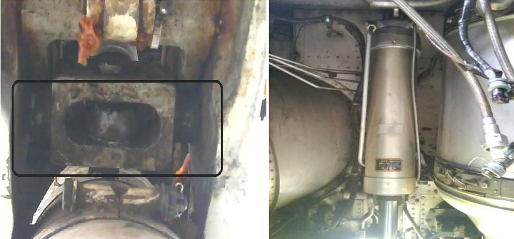
**Figura N.- 62** Actuador instalado y asegurado
