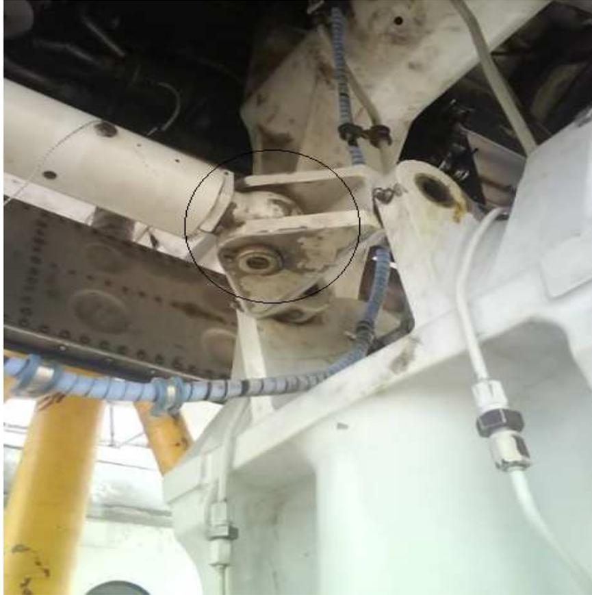
**Figura N.- 61** Parte posterior del Lock Strut colocado y asegurado
