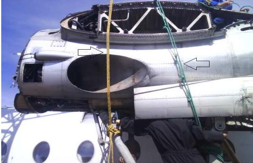
**Figura N.- 48** Cabos que sujetan al tren para elevarlo
