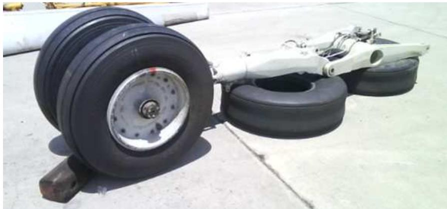
**Figura N.- 45** Tren de aterrizaje listo para ser montado
