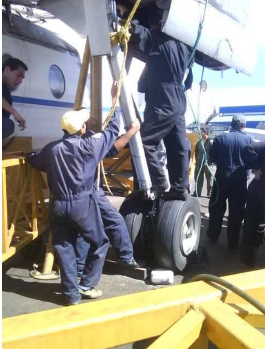
**Figura N.- 41** Drag strut durante el montaje del tren
