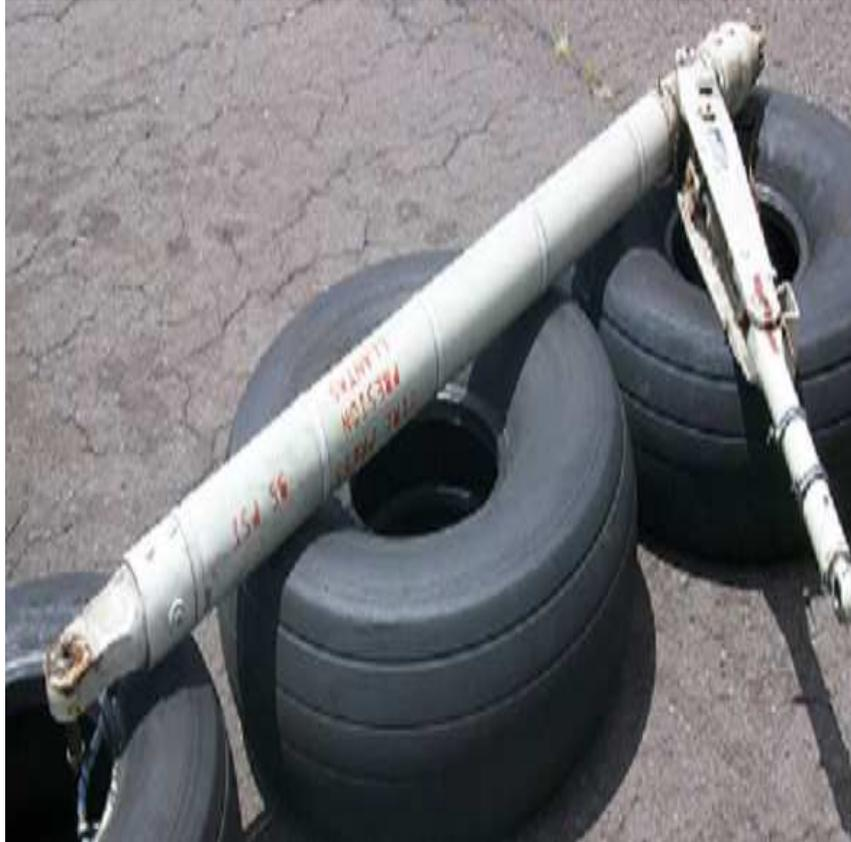
**Figura N.- 55** Drag Strut listo para ser instalado
