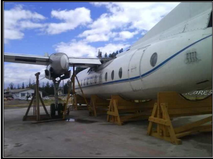
**Figura Anexo B:** Tren de aterrizaje principal derecho instalado en el ITSA
