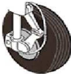
**Figura N.- 31** Frenos de disco
