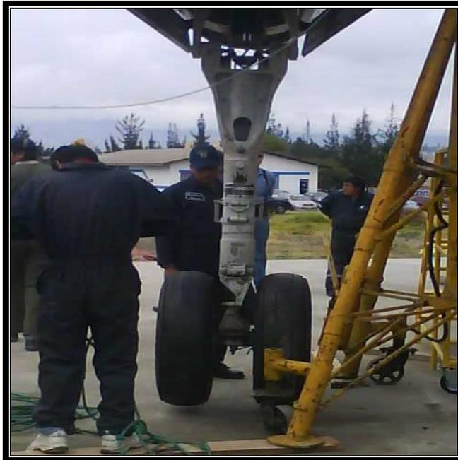
**Figura Anexo B:** Tren de aterrizaje sujetado en el ala central
