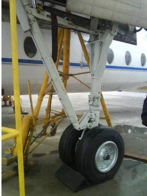
**Figura N.- 37** Estructura externa del tren del avión Fairchild ubicado en el ITSA
