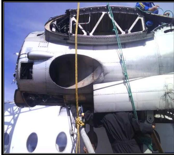
**Figura Anexo B:** Elevación del tren de aterrizaje con cabos
