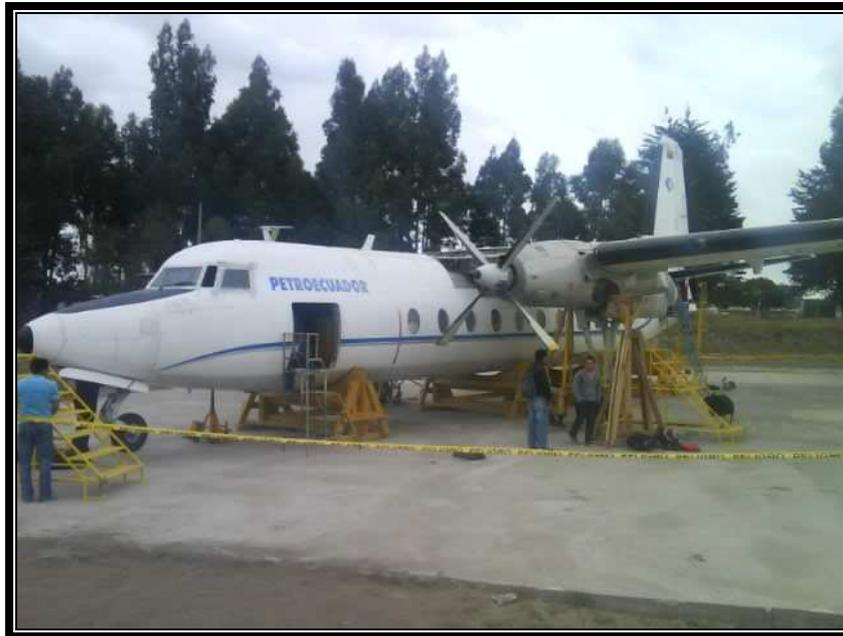
**Figura Anexo B:** Tren de aterrizaje del avión Fairchild instalado en el ITSA
