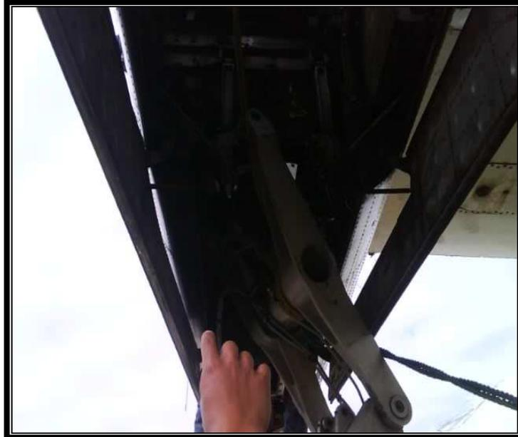
**Figura Anexo B:** Colocación del Upper member en el lugar del ala central.
