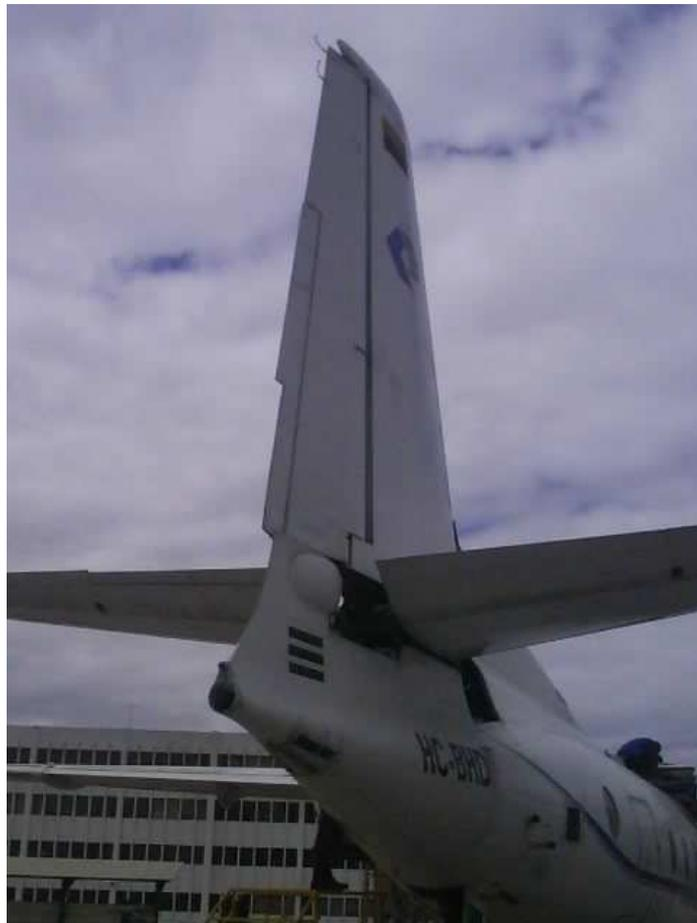
**Figura N.- 19** Estabilizador vertical del avión Fairchild ubicado en el campus del ITSA
