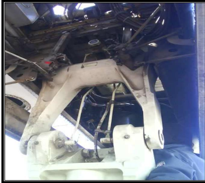
**Figura Anexo B:** Upper Member sujetado con los pins en el ala central.
