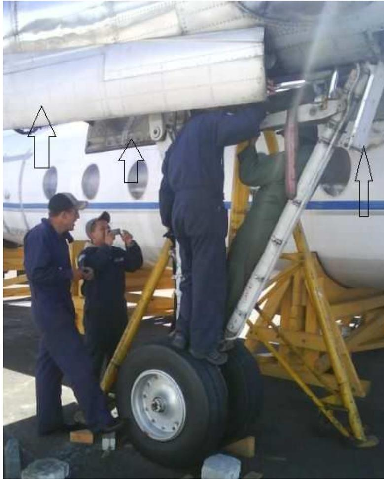
**Figura N.- 43** Puertas principales y delantero del tren de aterrizaje
