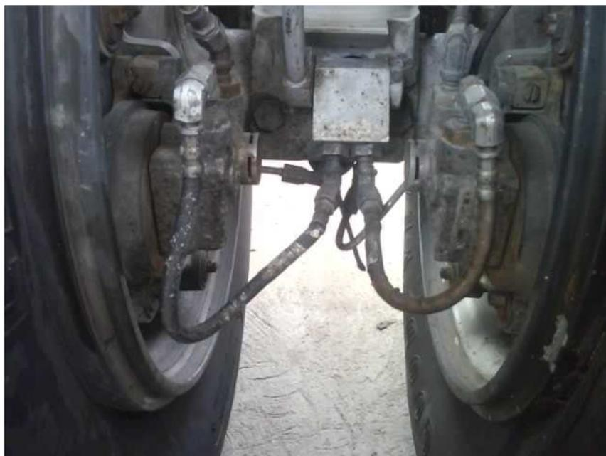
**Figura N.-25**Frenos del tren de aterrizaje del avión Fairchild ubicado en el ITSA
