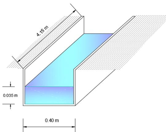
*Nota.* La figura muestra el largo, ancho y profundidad para determinar el área del canal.
