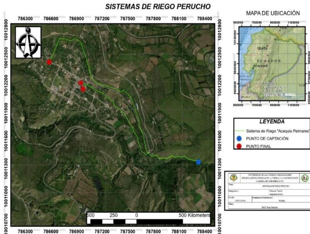
*Nota.* Sistemas de riego parroquia de Perucho con sus puntos de captación y final de cada canal de riego. Tomado de Autoría propia.
