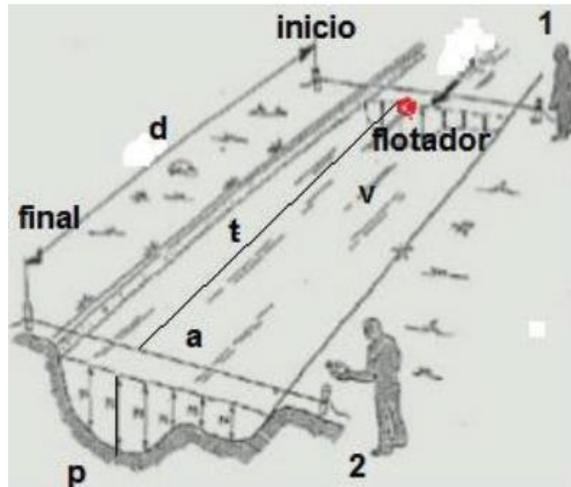
*Nota.* La figura muestra el procedimiento para realizar el aforo mediante flotadores. Tomado de Guía práctica para aforar en canales y cauces naturales (pg. 63), por L. Hidalgo Tamayo, 2017, Escuela Politécnica Nacional.
