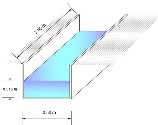
*Nota.* La figura muestra el largo, ancho y profundidad para determinar el área del sistema de riego Acequia Baja Alchipichí.
