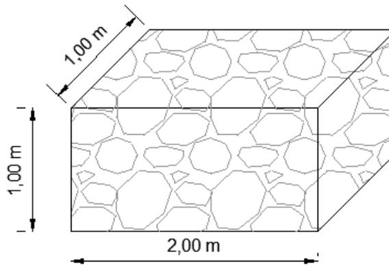
*Nota.* La figura muestra las dimensiones de un bloque de gavión.
