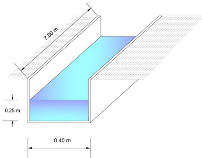
*Nota.* La figura muestra el largo, ancho y profundidad para determinar el área del sistema de riego Acequia alta La Josefina.
