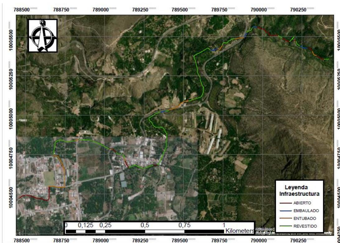
*Nota.* El gráfico muestra la ubicación geográfica del sistema de riego Alchipichí, y especifica dicha infraestructura de cómo está compuesto el canal. Fuente: propia.
