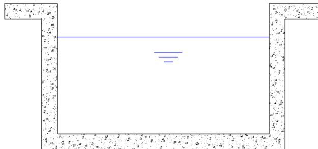
*Nota.* La figura muestra la sección que tienen los canales de riego tanto de la parroquia de Puéllaro como la de Perucho.
