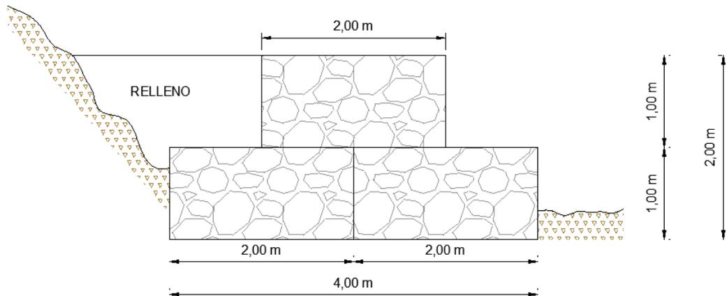
*Nota.* La figura muestra las dimensiones que se ocuparán para el muro de gaviones.
