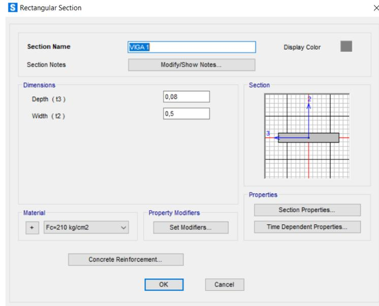
*Nota.* La figura muestra las dimensiones de la profundidad y ancho ingresadas en el software computacional SAP2000.
