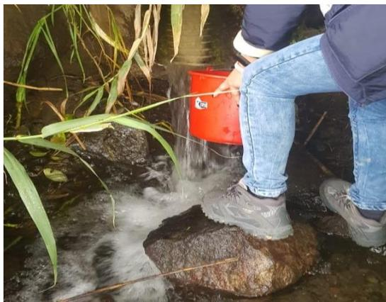
*Nota.* La figura muestra el recipiente de 10 litros ocupado para el aforo volumétrico que se utilizó en el sistema de riego Marianita.
