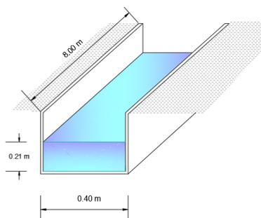
*Nota.* La figura muestra el largo, ancho y profundidad del sistema de riego El Turo.
