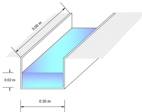
*Nota.* La figura muestra el largo, ancho y profundidad del sistema de riego Acequia del Pueblo.
