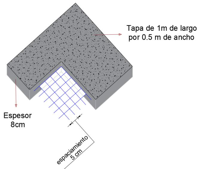
*Nota.* La figura muestra que el esquema de la tapa para el embaulamiento, construida con Malla Armex R196(10x10X5).
