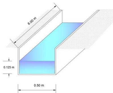
*Nota.* La figura muestra el largo, ancho y profundidad del sistema de riego Piango.
