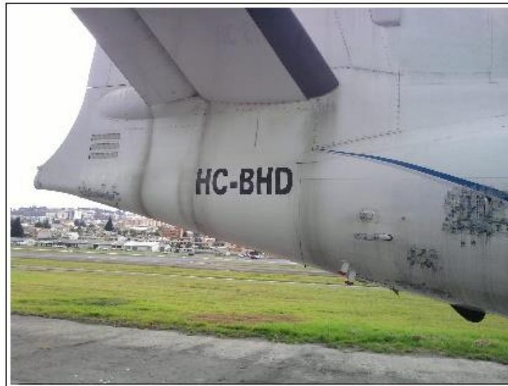
Figura 1.7.-Empenaje del Avión Fairchild FH-227
