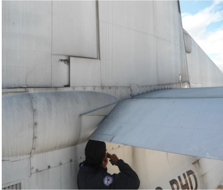
Figura N° 22 Paneles del estabilizador horizontal
