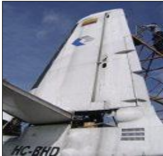
Figura N° 29 Inspección de los pernos de sujeción del empenaje
