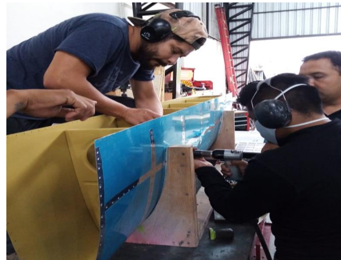
Remachado del refuerzo
