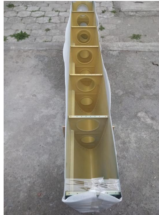
Refuerzo del borde de ataque
