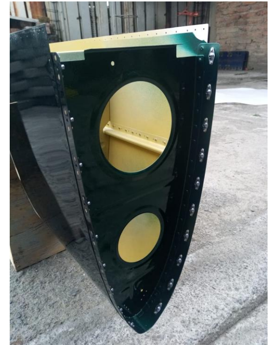
Tira de unión del borde de ataque
