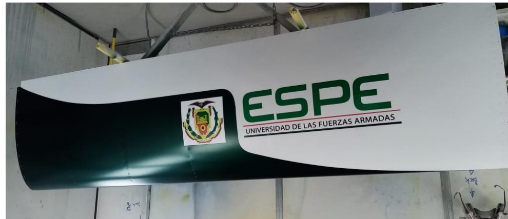
Colocación de stickers y barniz
