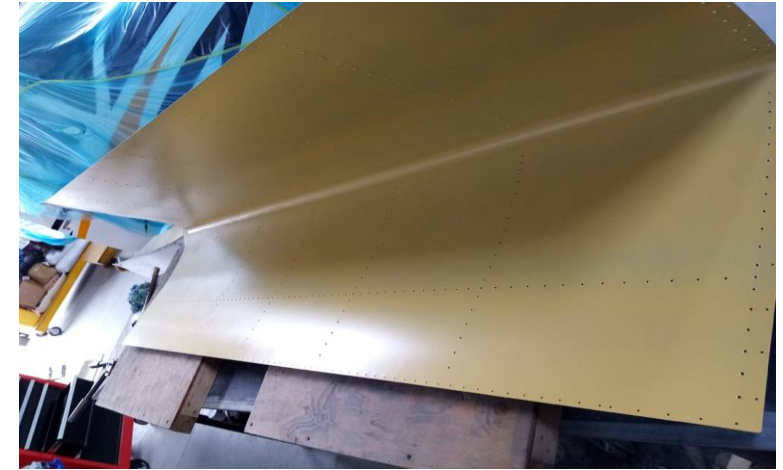
Aplicación de primer en la parte interior del alclad
