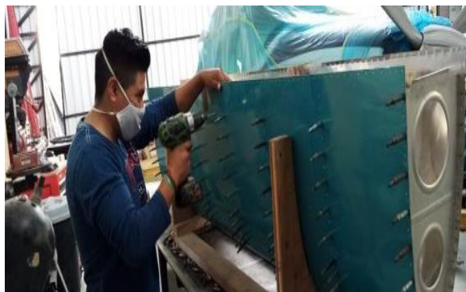
Taladro con broca # 40 y colocación de clecos
