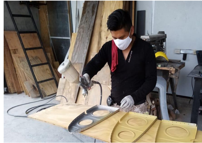
Aplicación de primer costillas
