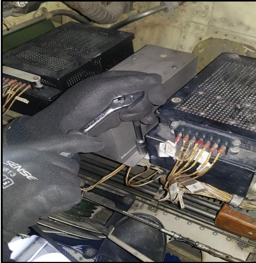
**Figura 24 Remisión de la Batería de la aeronave**
