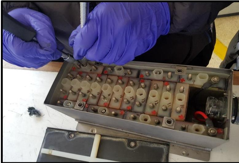
**Figura 32 Extracción de válvulas**
