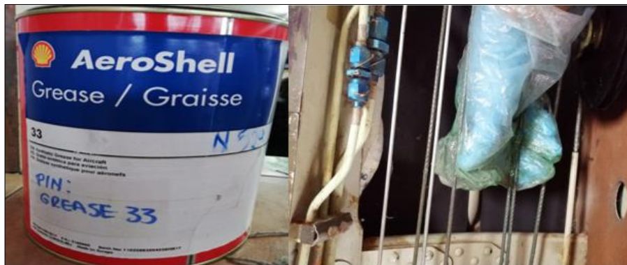
Figura 70 Lubricación de los cables del elevador
