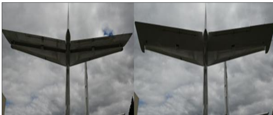
Figura 73 Prueba de movimiento del elevador
