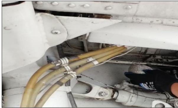
Figura 37 Limpieza de cables del alerón
