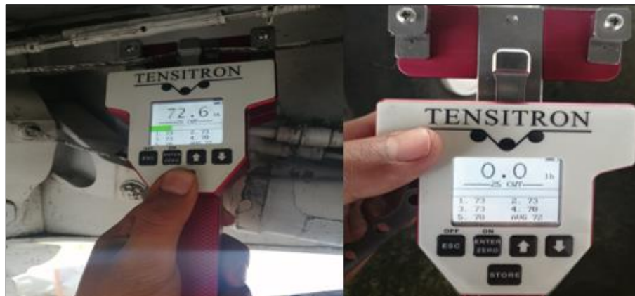
Figura 39 Verificación de tensión de cables del alerón
