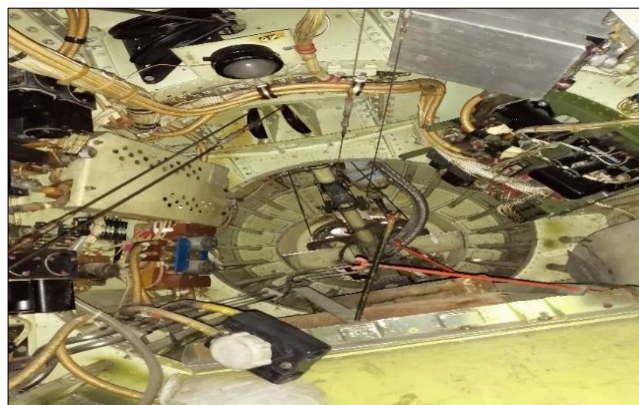
Figura 48 Paneles de acceso del rudder libres
