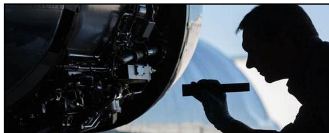
Figura 20 Localización de fugas y defectos Fuente: (Areanas, 2011)
