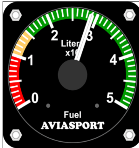
Figura 15 Indicador de cantidad De combustible Fuente: (Aircraft Spruce, 2015)
