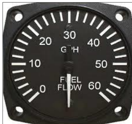
Figura 14 Indicador de flujo de Combustible
