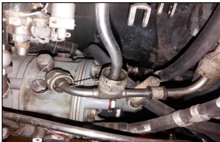
Figura 29 Bomba de combustible
