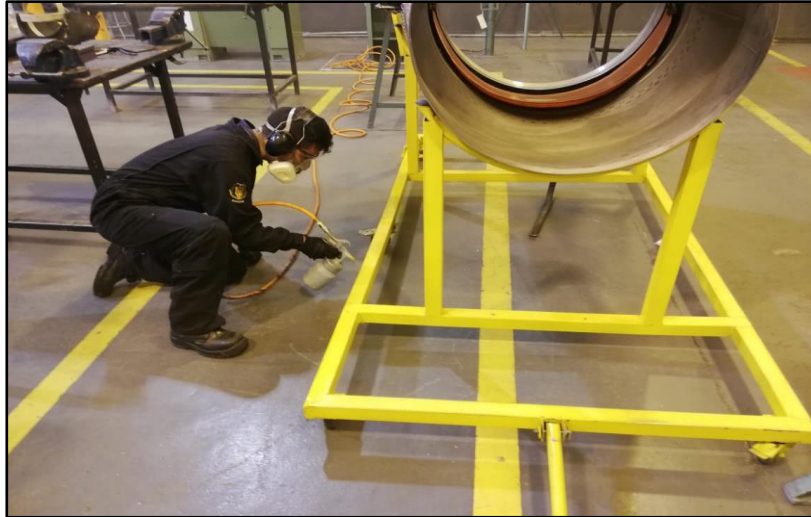
Figura 31 Aplicar el esmalte amarillo al soporte
