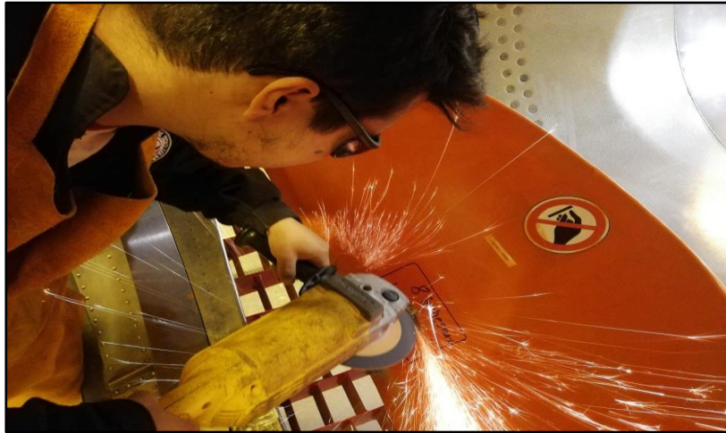
Figura 23 Desbaste de pintura con la rotaflex
