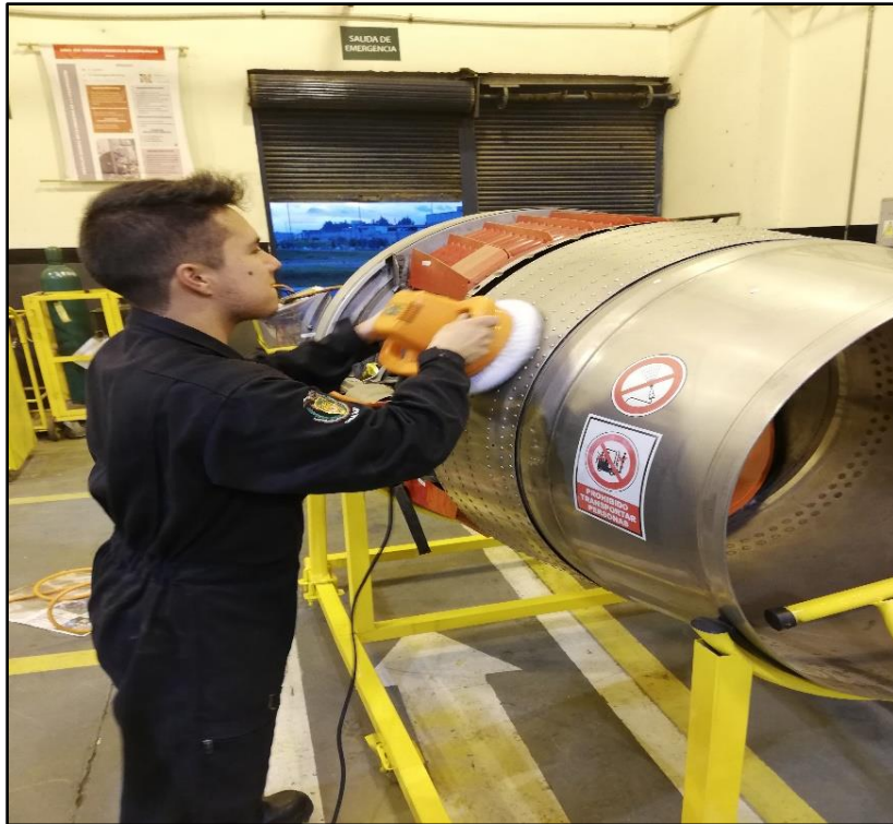
Figura 56 Pulida de la carcasa anterior
