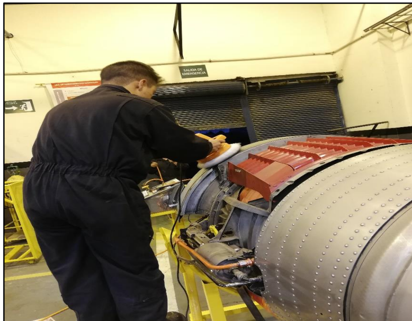
Figura 57 Pulida de la carcasa anterior
