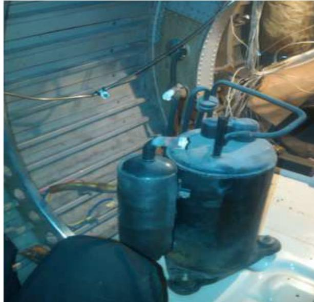
**Figura 3.24:** Montaje del motor compresor del aire acondicionado
