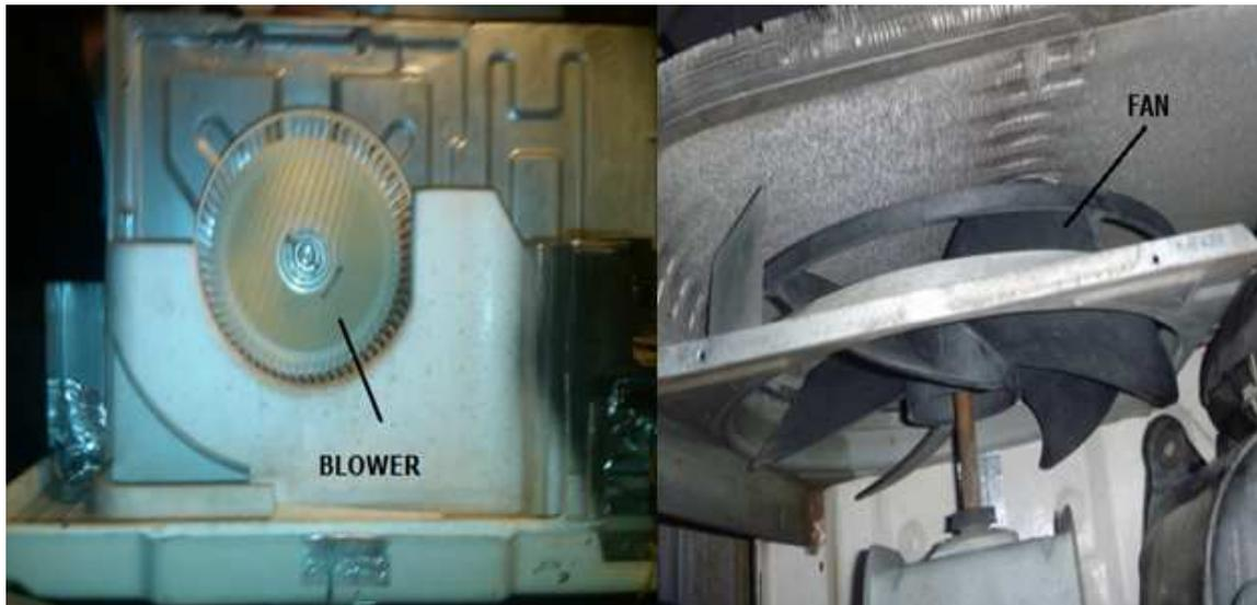
**Figura 3.27:** Montaje del blower y fan del aire acondicionado
