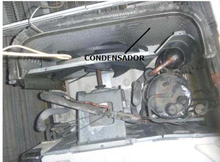
**Figura 3.28:** Montaje del condensador del aire acondicionado
