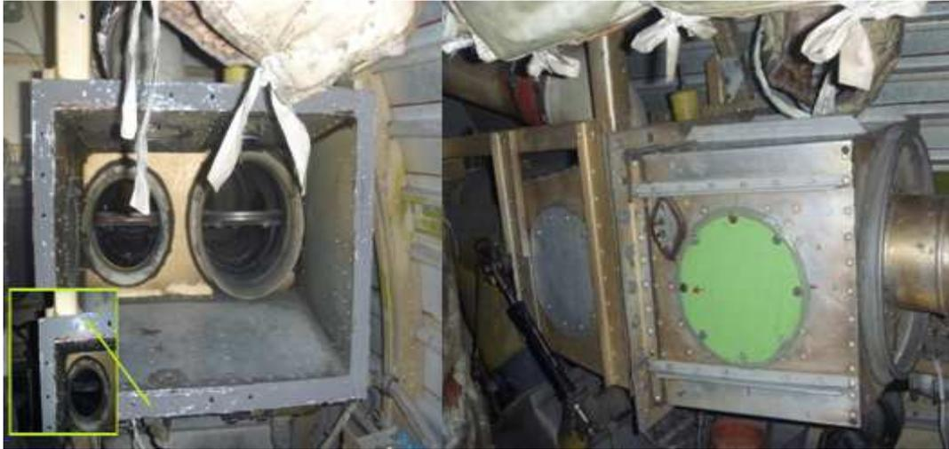
**Figura 3.44:** Sellado del cono mezclador de aire
