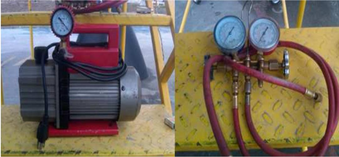
**Figura 3.32:** Bomba y manómetros de vaciado
