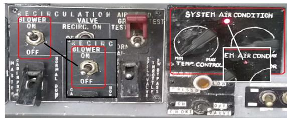
8. Cuando la lamparilla del panel lateral del copiloto se haya apagado proceda a desenergizar el avión desconectando cuidadosamente la toma de energía que se encuentra en el compartimiento de aire acondicionado en la estación 655 del avión Fairchild F-227 y desconecte el enchufe de 220V ac, del toma corriente del taller de reparaciones menores.
