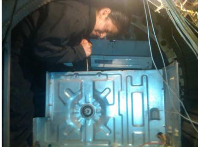
**Figura 3.25:** Montaje de la placa lateral del aire acondicionado
