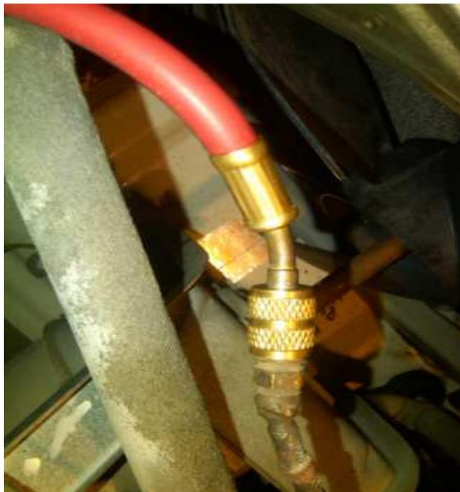
**Figura 3.33:** Succión de aire y humedad
