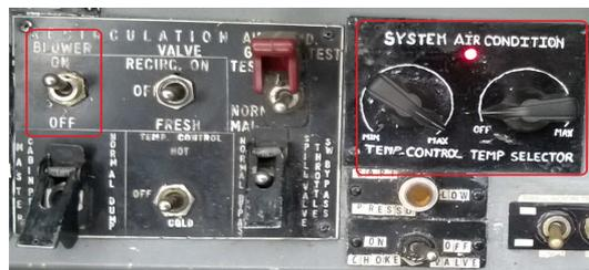
7. Para el apagado del sistema gire las perillas a los puntos MIN y OFF y el switch en OFF.
