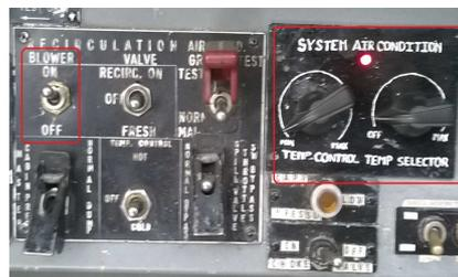
5. El selector de temperatura (SELECTOR TEMP), activa el compresor, gire la perilla hasta la posición deseada, esta perilla controla el empuje de aire deseado en cabina en un rango de 5 posiciones teniendo desde OFF a MAX en incremento.
