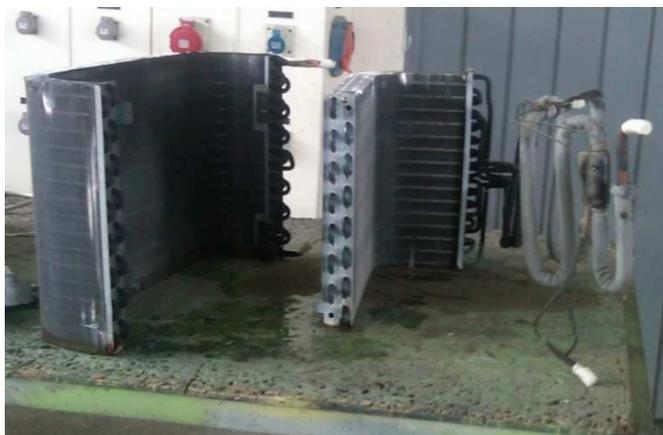
**Figura 3.13:** Desoldado de cañerías de cobre y cubierta de las mismas
