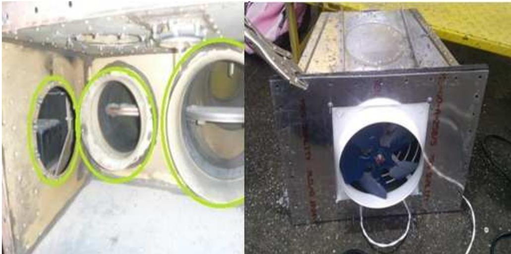
**Figura 3.43:** Sellado de las entradas de aire del motor y colocación del fan
