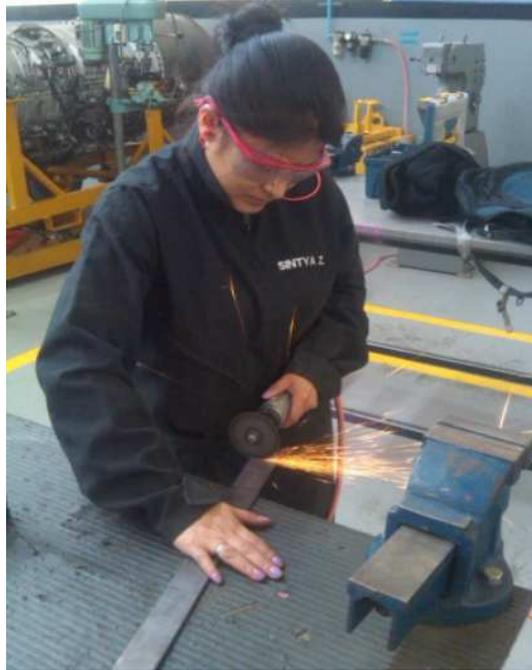
**Figura 3.6:** Corte de la lamina de hierro
