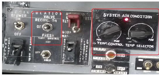
6. El control de temperatura (CONTROL TEMP), da el grado de enfriamiento a la cabina, gire la perilla según la temperatura deseada en cabina, esta perilla tiene 10 posiciones desde MIN a MAX en incremento.
